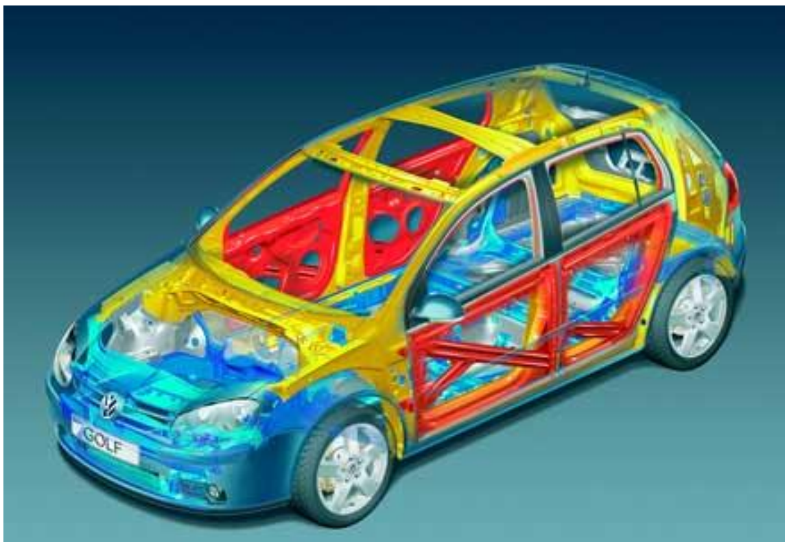
Рисунок 9 - Элементы программируемой деформации кузова
