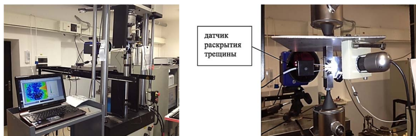
Рис. 9.3. Испытательный комплекс с образцом, установленным в захватах, и камерой видеонаблюдения
