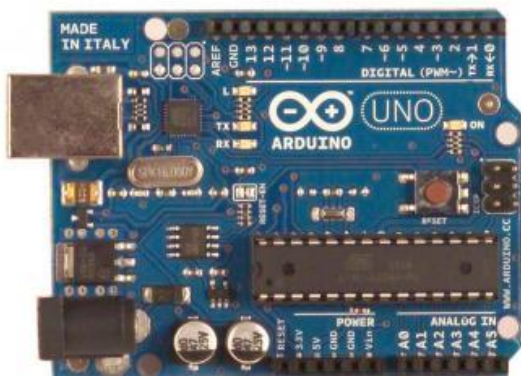
Рис.11. Лицевая сторона платы Arduino Uno
