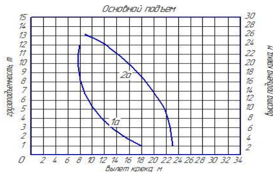
График грузоподъемности крана Ст2-2-40 L=18\text{м}
