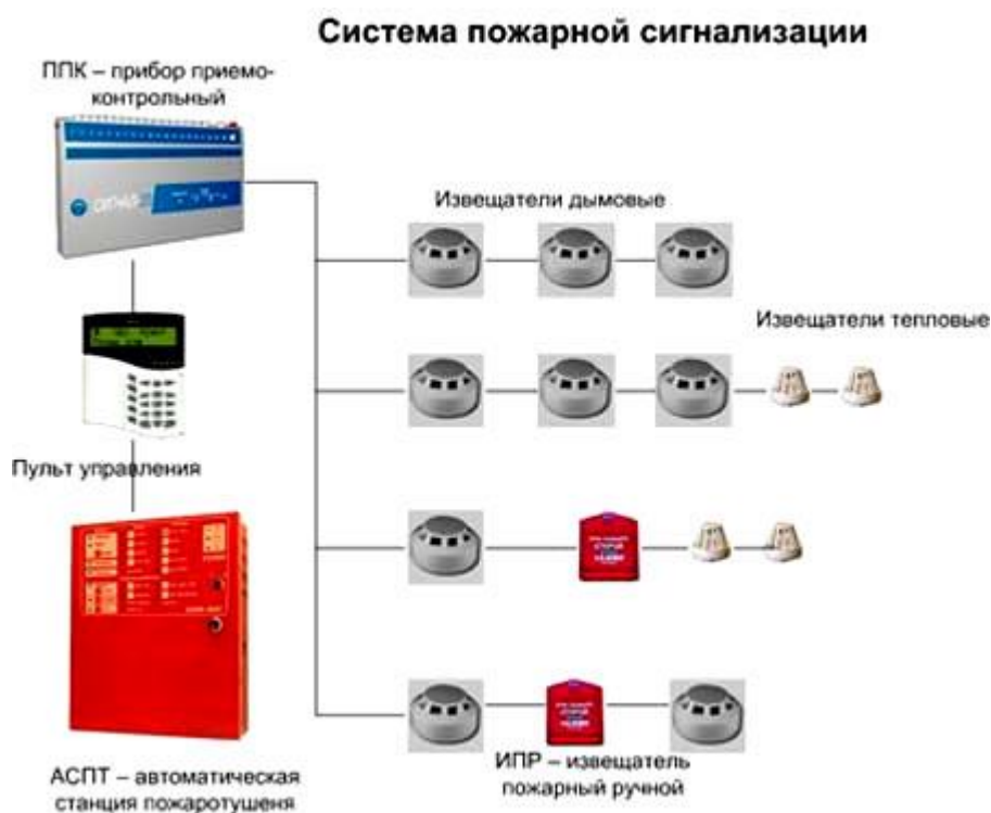
Рисунок 2 – Состав системы пожарной сигнализации
