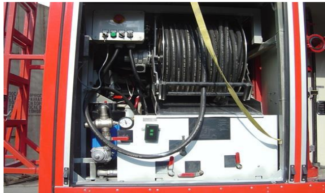
Рисунок 9 – Отсек размещения установки пожаротушения «Кобра»
