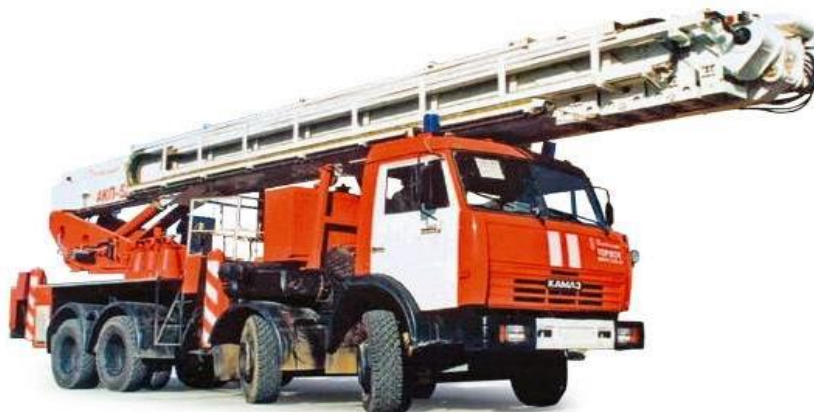
Рисунок 2 – Автоподъемник коленчатый пожарный АКП-50 (КамАЗ-6540)
