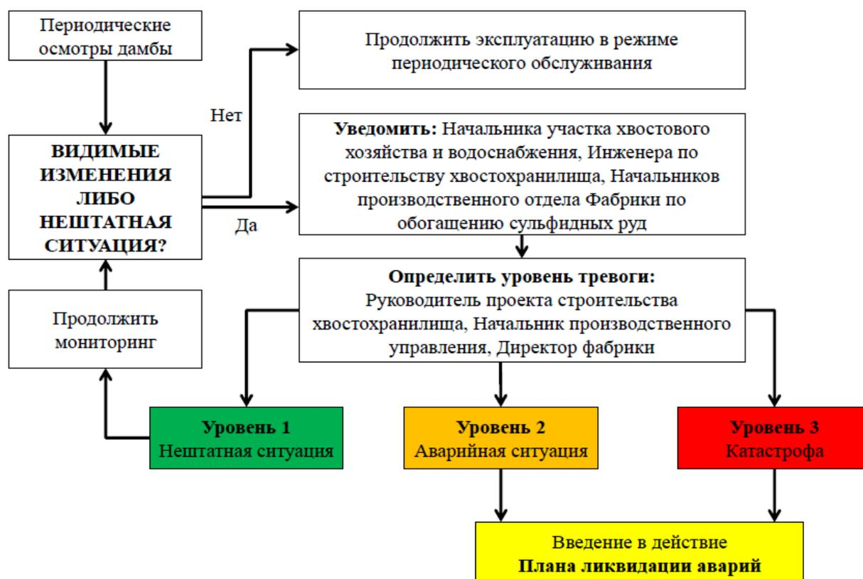
Рисунок 3 – Определение уровня оповещения и приведение в действие плана ликвидации аварии
