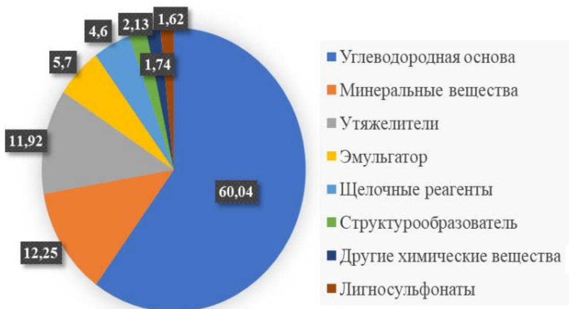
Рисунок 2 – Процентное соотношение химических составляющих в РУО: бентонитовые глины, лигниты, понизители фильтрации, гильсонит, смачивающие реагенты, понизители вязкости [3]
