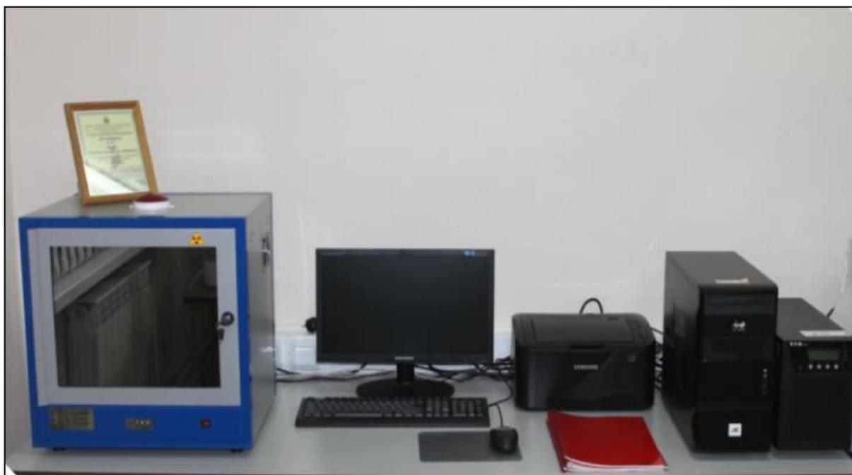
Рисунок б – Рентгеновский минидифрактометр «Радиян» (ДР-01) с комплектом оборудования
