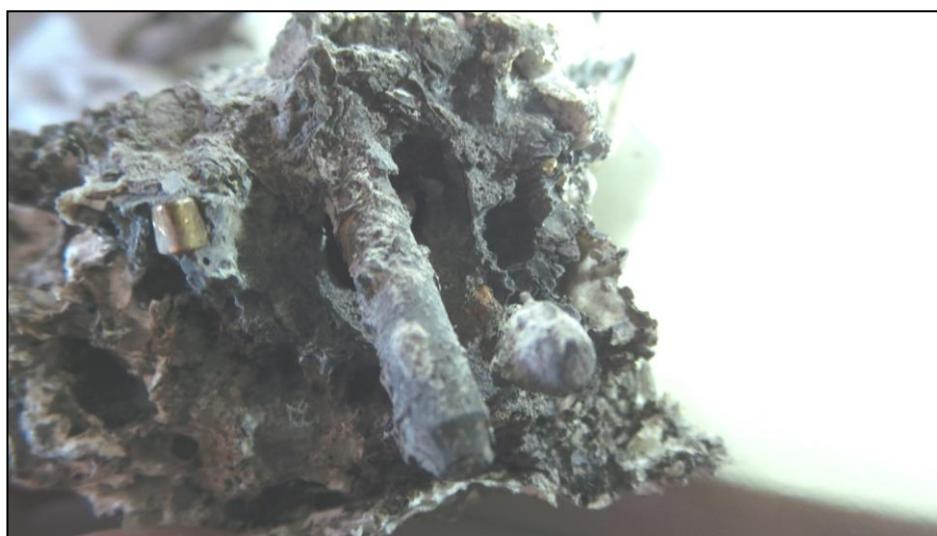
Рисунок 33 – Микродуговые оплавления на конце штыревого контакта
