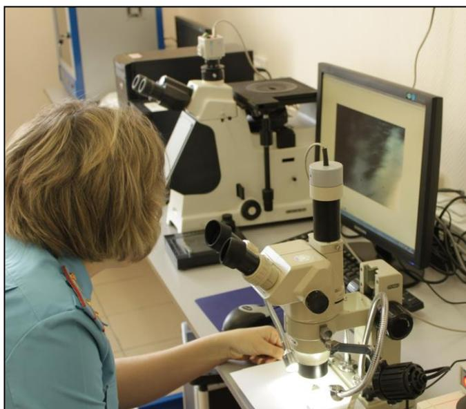
Рисунок 5 – Микроскоп стереоскопический панкреатический «МСП–ТМ» со специализированной цифровой видеокамерой «Фотон» ВК-8112 и видеоадаптером ВА-9819
