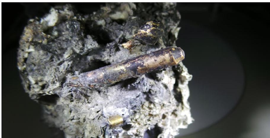
Рисунок 32 – Электрические контакты вилки в агломерате
