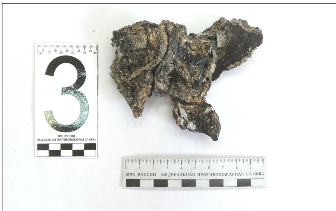
Рисунок 23 – Электрические проводники с многопроволочными жилами различного сечения
