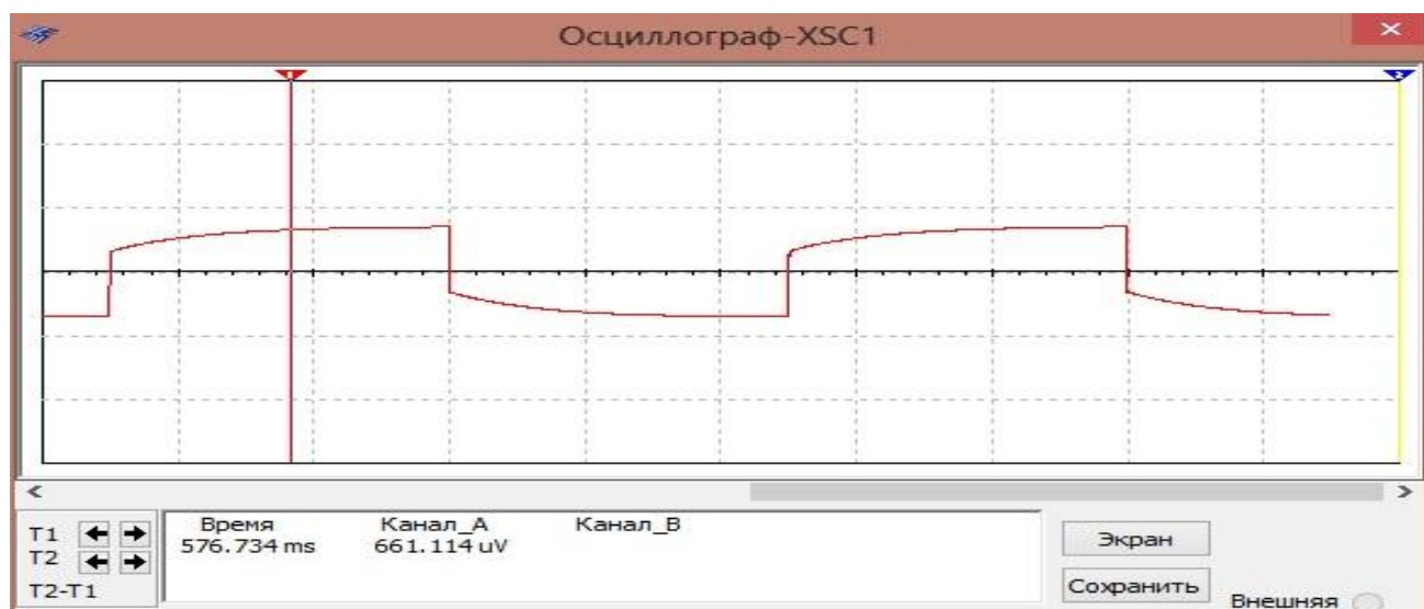
Рисунок 2.8 – Выходное напряжение стабилизатора, измеренное в режиме работы AC осциллографа
