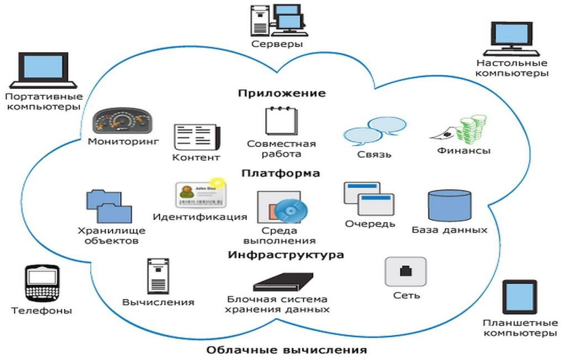
Рисунок А.1 - Общая схема работы облачных технологий
