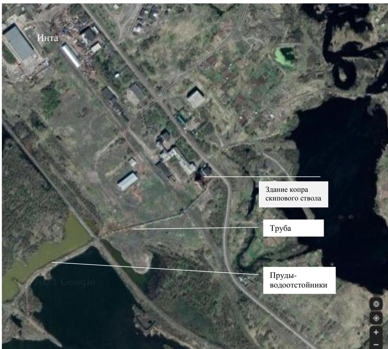
Рисунок 1 – Расположение водоотлива шахты «Глубокая»
