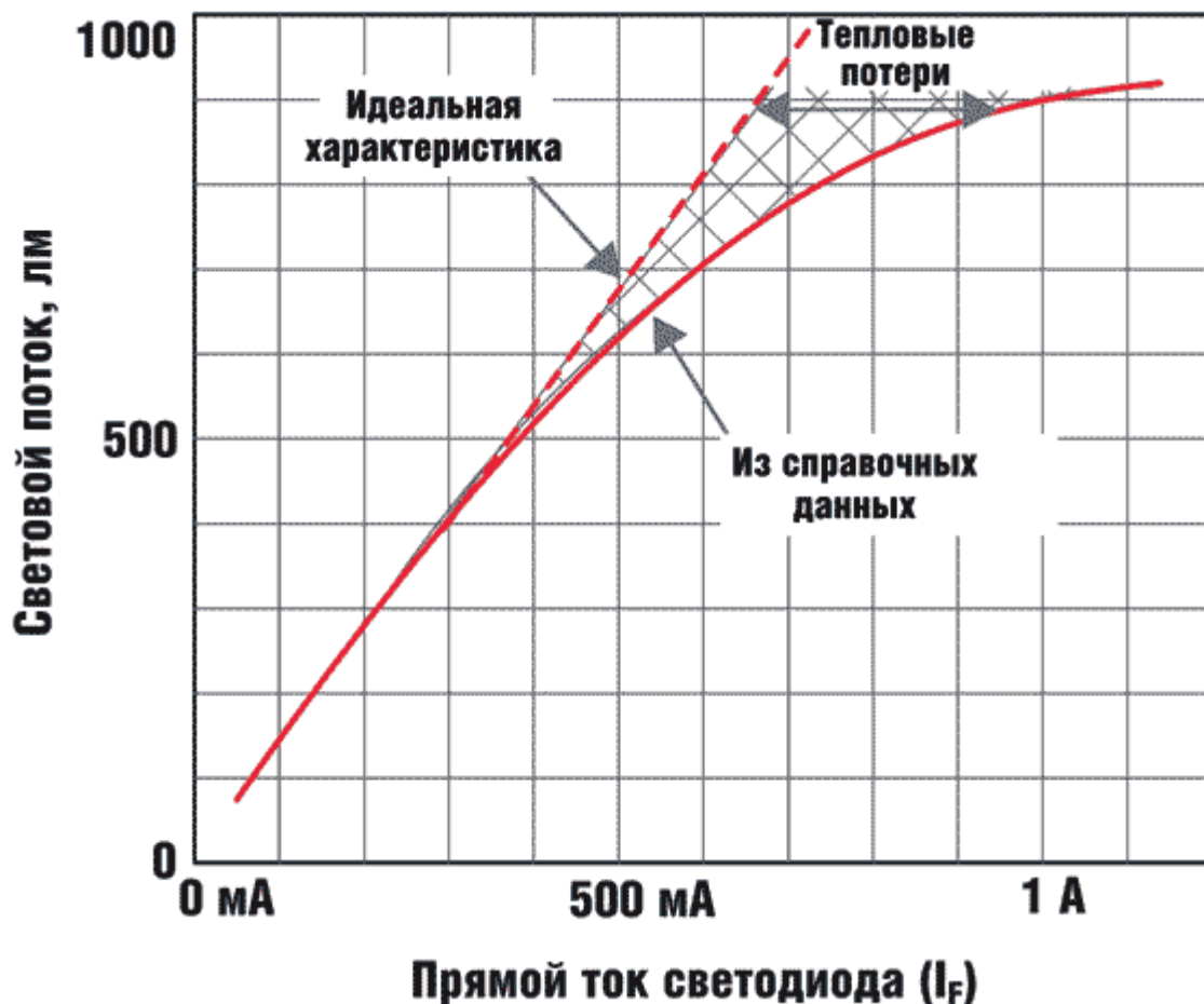
Рисунок 1.2. — Зависимость светового потока от тока через светодиод
