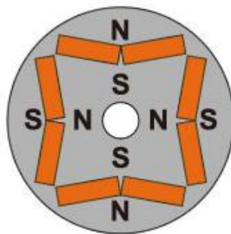
Рисунок 5 – Ротор синхронного двигателя со встроенными магнитами.
