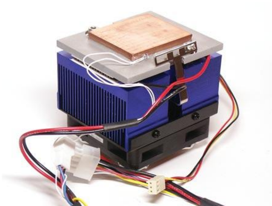
Рисунок 5 – применение конструкции с ТЭМ для охлаждения процессора компьютера
