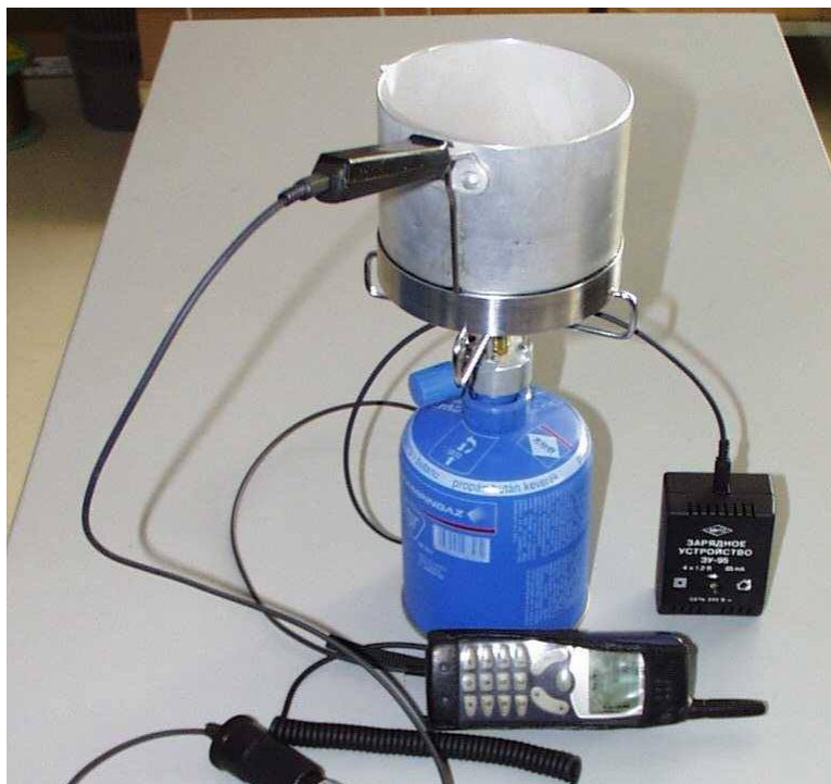
Рисунок 7 – Использование ТЭМ для зарядки телефона
