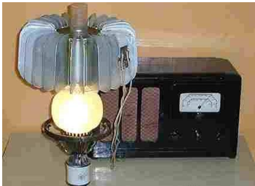
Рисунок 6 – Применение ТЭМ для питания радиоприёмника
