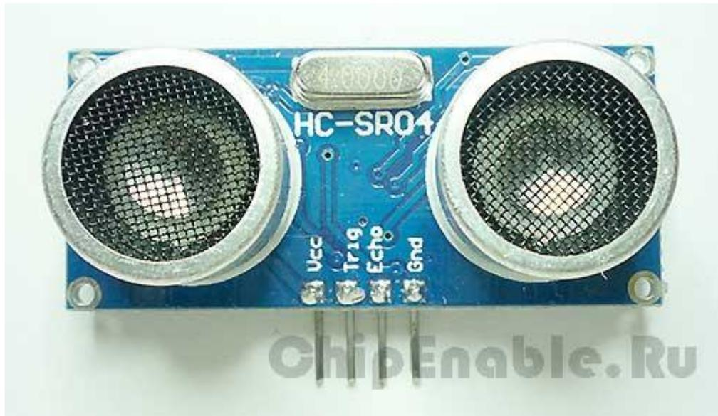
Рисунок 17 – Внешний вид ультразвукового дальномера HC-SR04.
