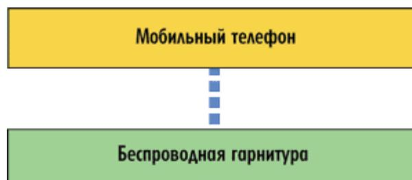
Рисунок 8 - Схема пикосети,
