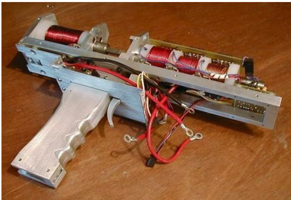
Рисунок 1.1 – Устройство, использующее магнитное поле для линейного ускорения снаряда
