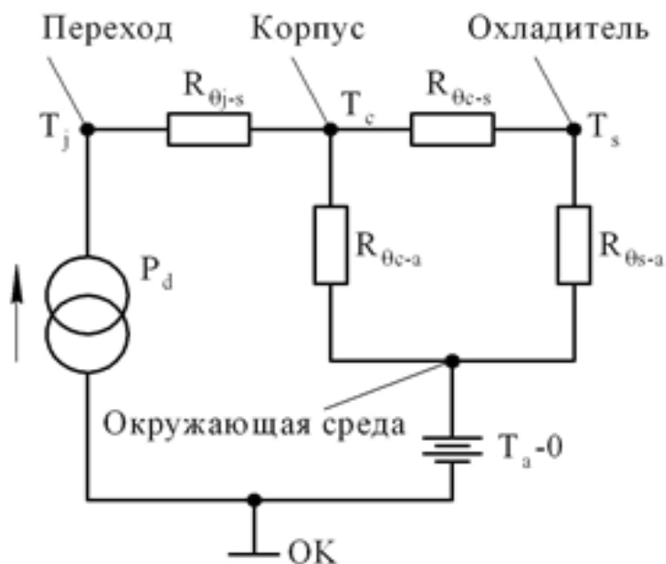
Рисунок 16- Термоэлектрическая схема замещения
