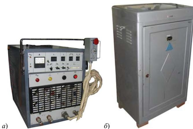
Рис. 7. Внешний вид сварочного выпрямителя:
