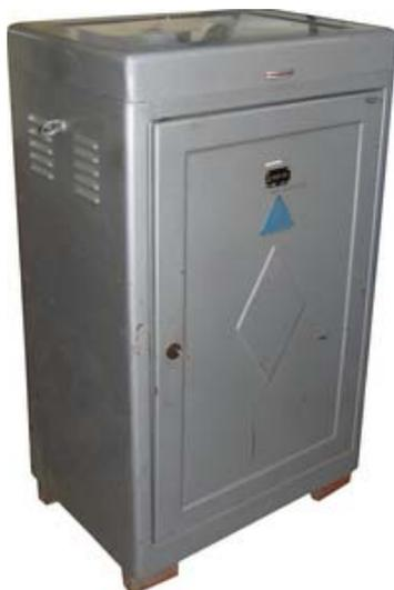
Рис. 12. Внешний вид сварочного выпрямителя ВСП-160 («Электромеханика», г. Ржев)
