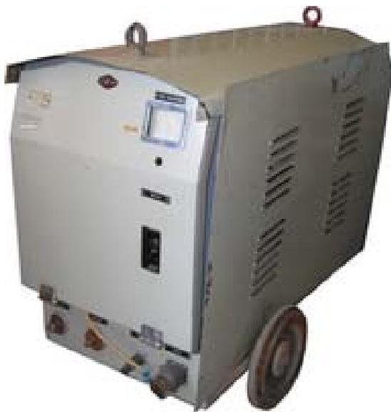
Рис. 24. Сварочный выпрямитель ТИР-300Д
