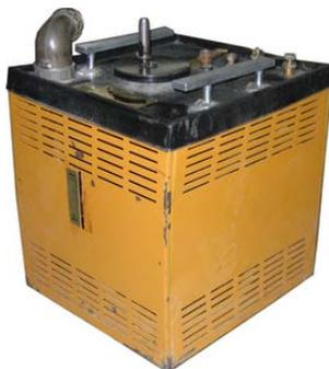
Рис. 4. Внешний вид сварочного выпрямителя ВДУ-20У2
