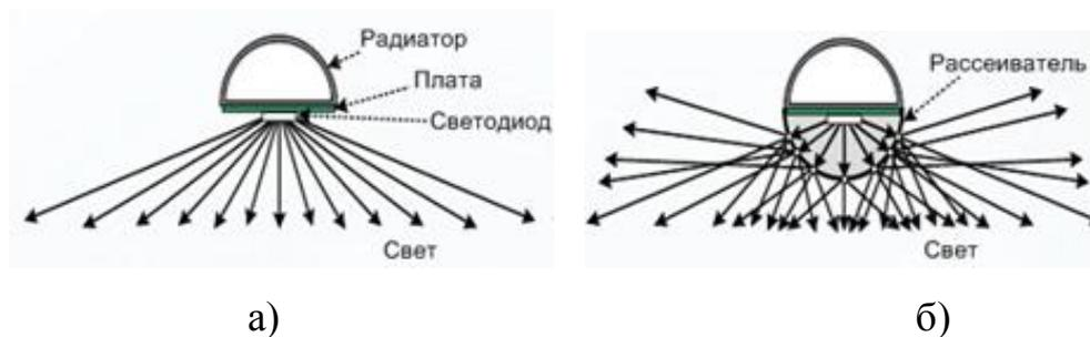
Рисунок 1.6 – Светильник без (а) и с рассеивающей крышкой (б)
