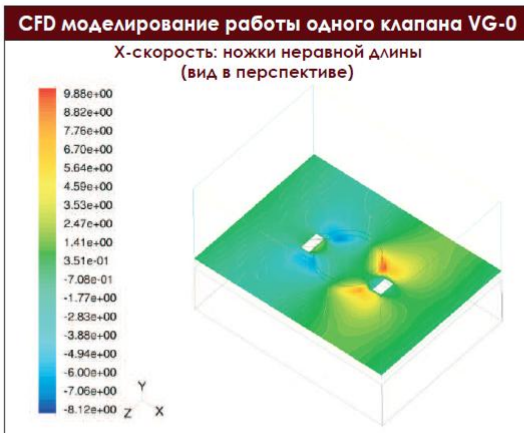
Рис.5 CFD моделирование работы одного клапана
