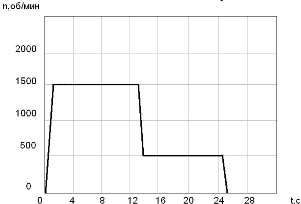
Рисунок 3.2 - Тахограмма рабочего механизма
