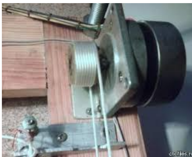
Рисунок 1.2 – Шаговый двигатель с тросовой передачей
