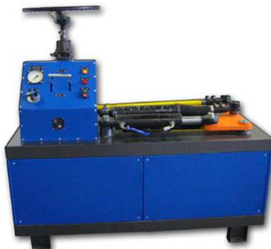
Рисунок 1.5 – Стенд для испытания ГУР
