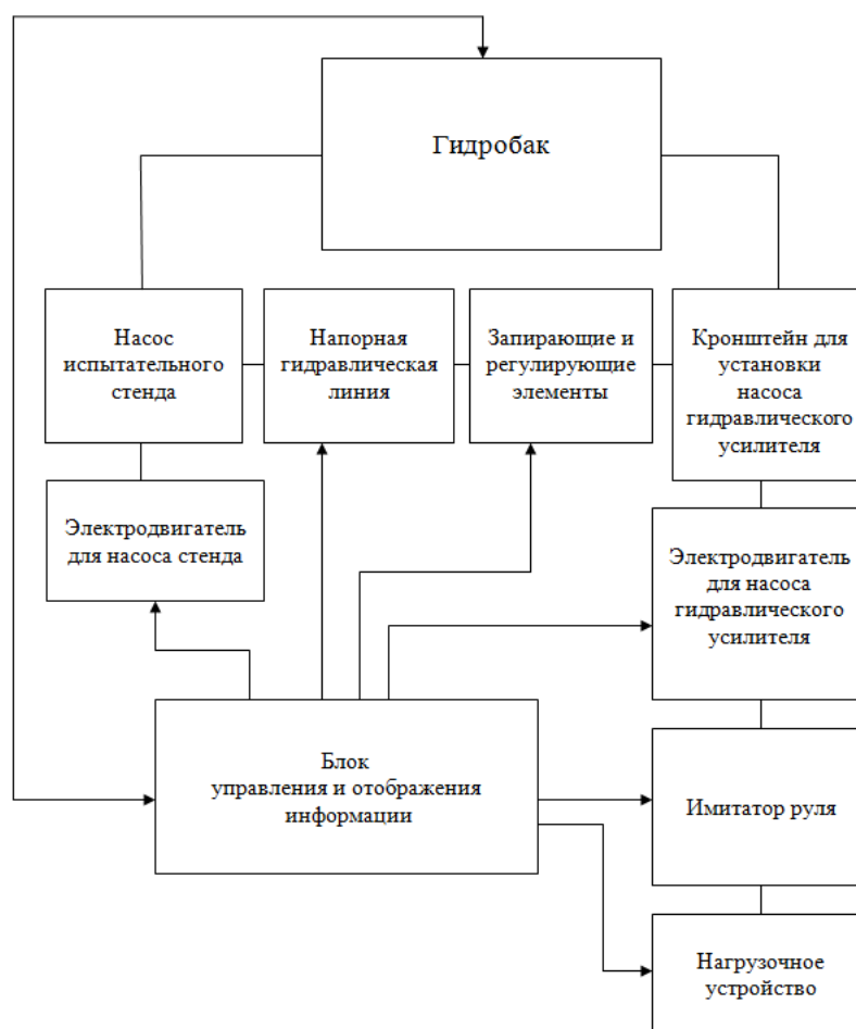
Рисунок 2.2 – Функциональная схема испытательного комплекса системы гидравлического усилителя руля
