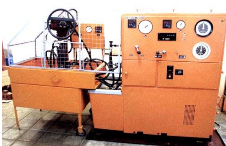
Рисунок 1.6 – Стенд для испытания и регулировки гидронасосов КИ-28097-02М
