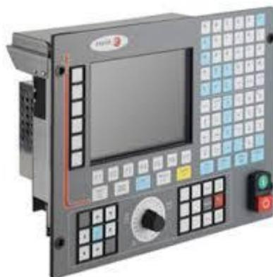
Рисунок 3.1 - Внешний вид центрального блока системы ЧПУ Fagor
