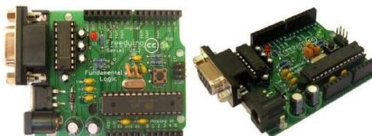
Рисунок 4.4 - Freeduino MaxSerial
