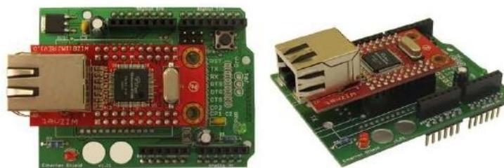
Рисунок 4.10 - Ethernet модуль E-Shield v1.21
