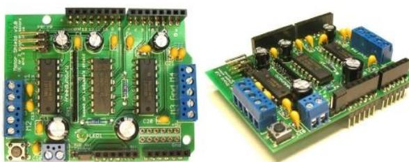
Рисунок 3.16 - Motor Shield v2 Kit
