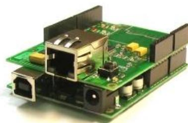
Рисунок 3.9 - Подключение модуля с помощью штекеров, установленных на нем, к Freeduino.
