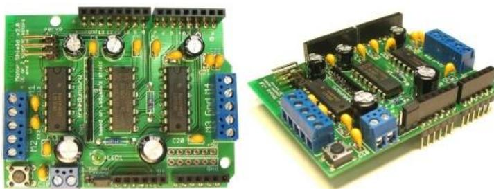
Рисунок 4.14 – На Motor Shield v2, который подключается с помощью разъемов
