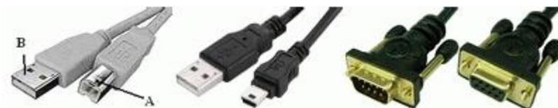
Рисунок 6.1 - Пример кабелей и их разъемов
