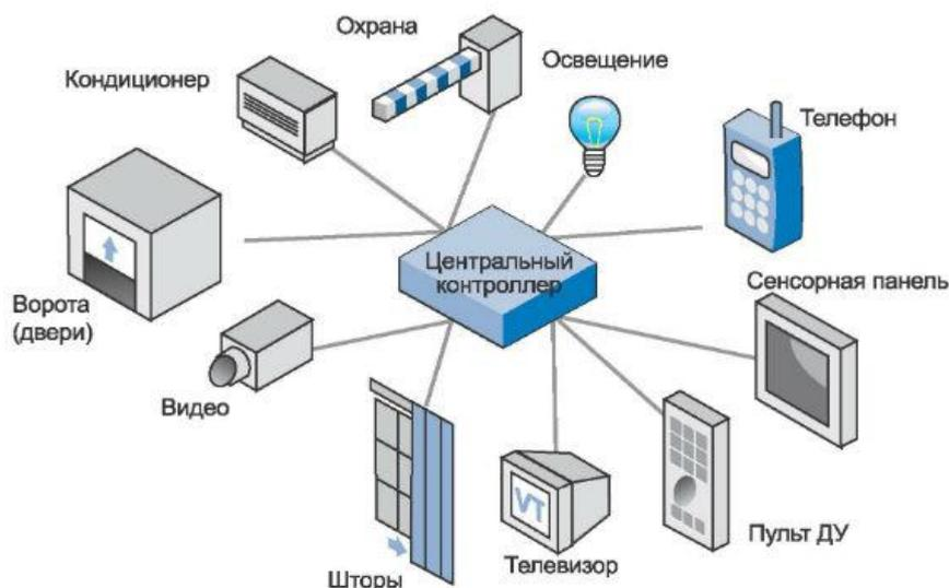
Рисунок 2.1 - Приборы, которыми управляет контроллер системы умного дома
