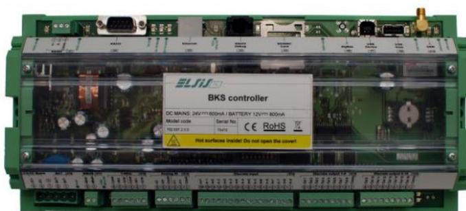
Рисунок 2.2 - Домовой центральный контроллер системы (модуль беспроводной передачи, USB, COM, Ethernet порты)
