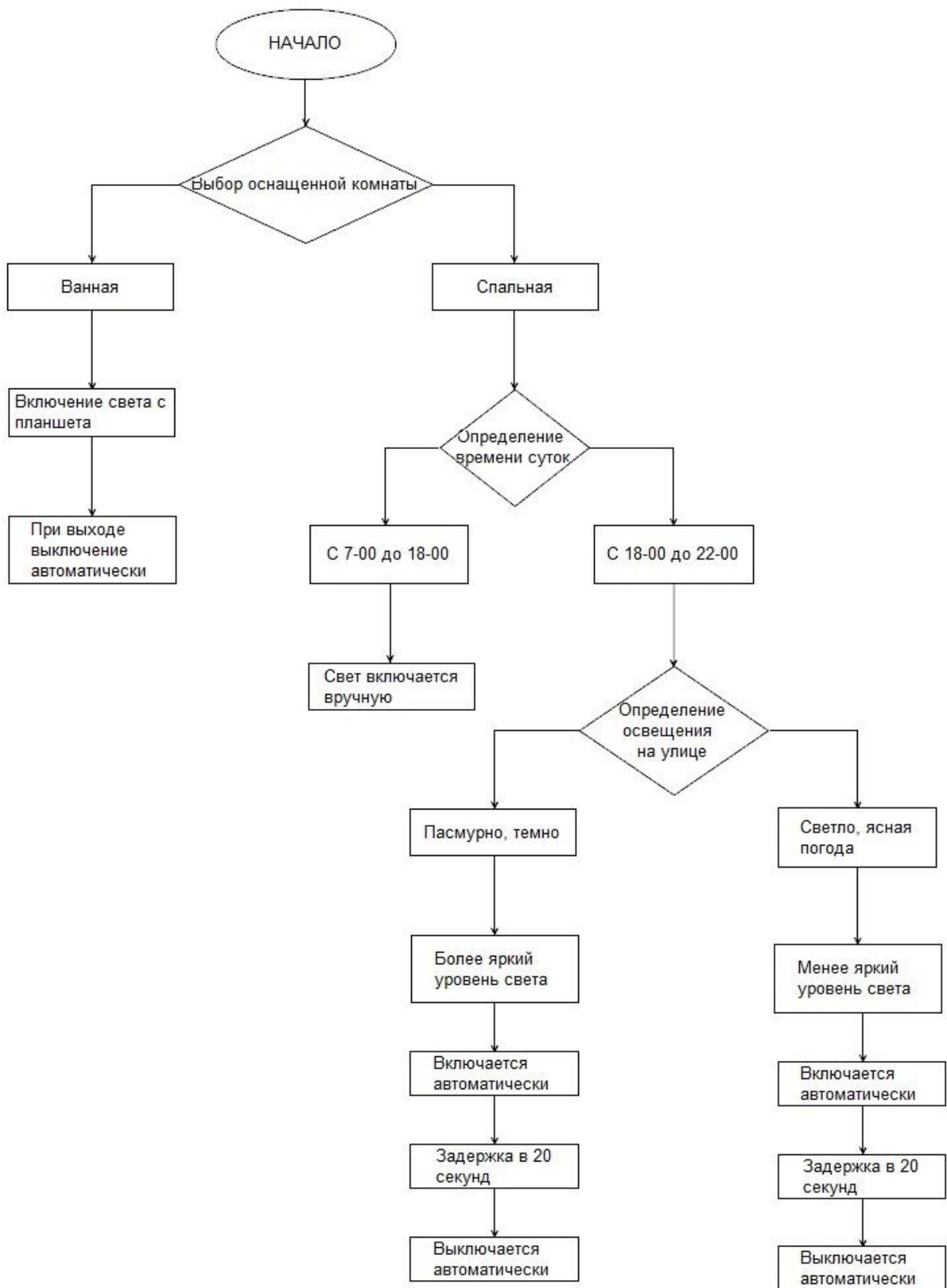
Рисунок 8.10 - Блок-схема алгоритма работы системы освещения
