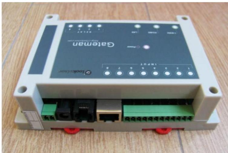
Рисунок 2.3 - Программируемый контроллер системы УД с интерфейсом Ethernet.
