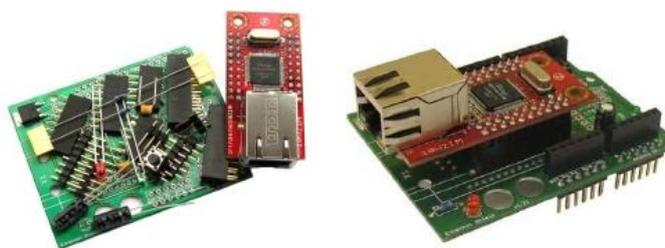
Рисунок 4.12 - Freeduino E-Shield v1.21 Kit
