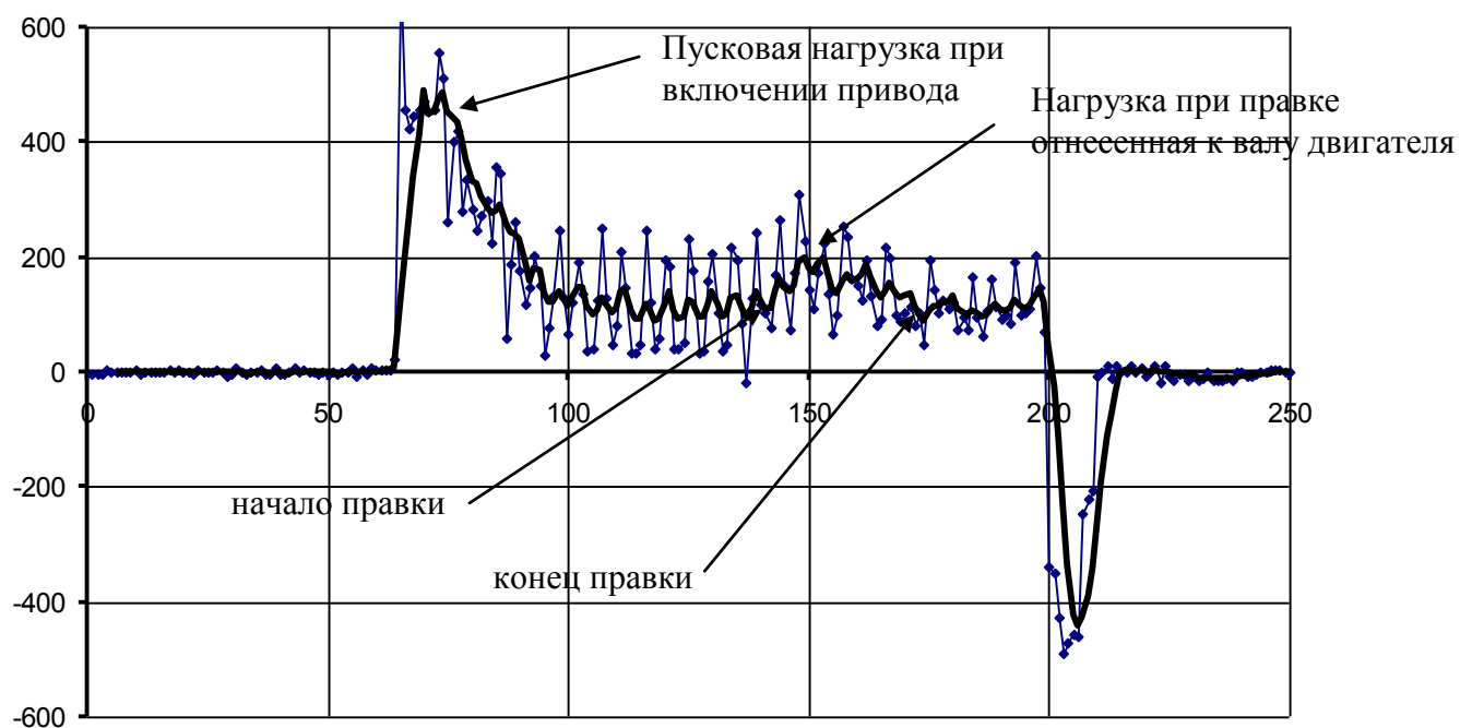
Рис. 4.8 Результат записи нагрузки на шпинделе вращения шлифовального круга при обычной правке
