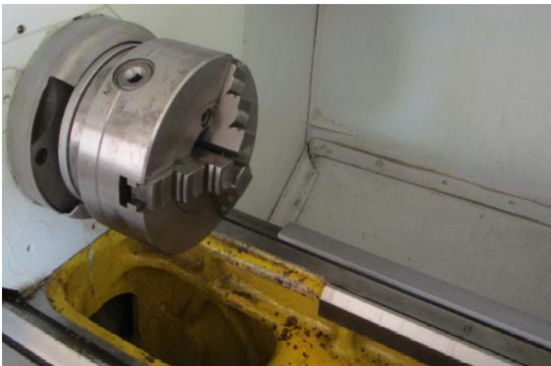
Рисунок 7.3 Трехкулачковый патрон перед установкой на него приспособления для технологического ужатия
