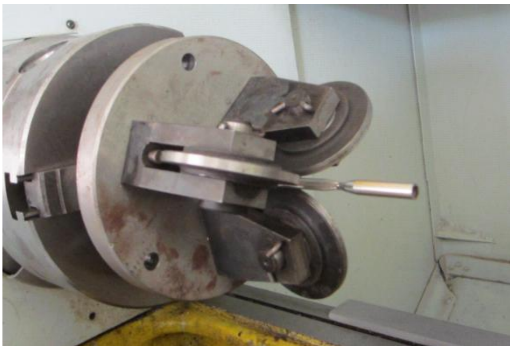
Рисунок 7.5 Ужатие штифта в специальной оснастке
