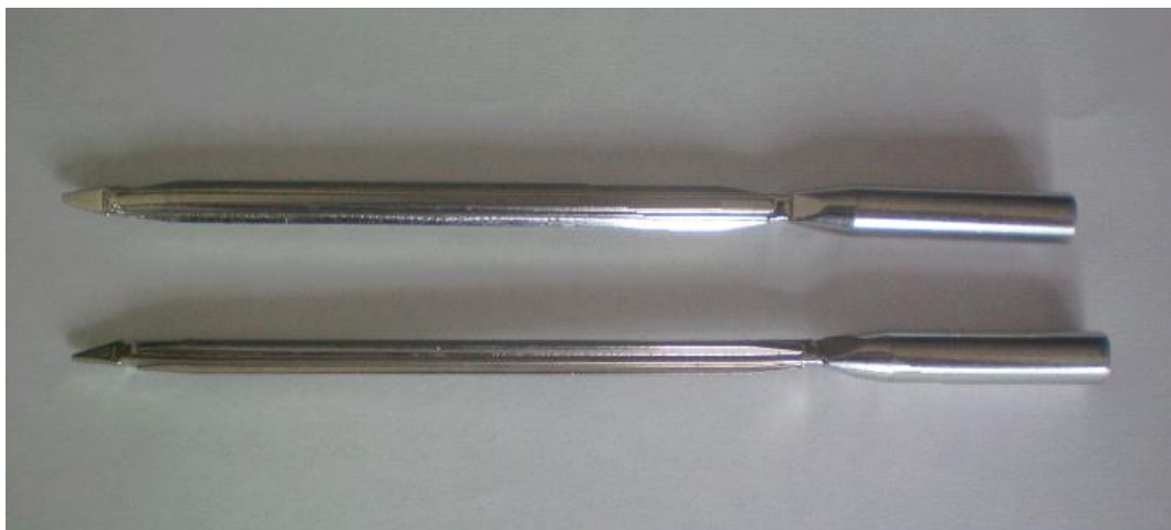
Рисунок 7.6 Состояния оболочки до ужатия и после него
