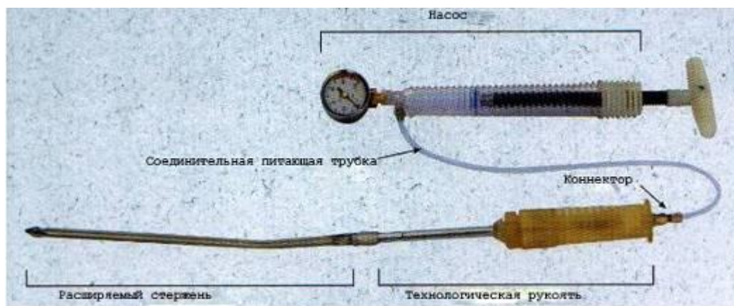
Рисунок 7.7 Набор для испытаний на герметичность
