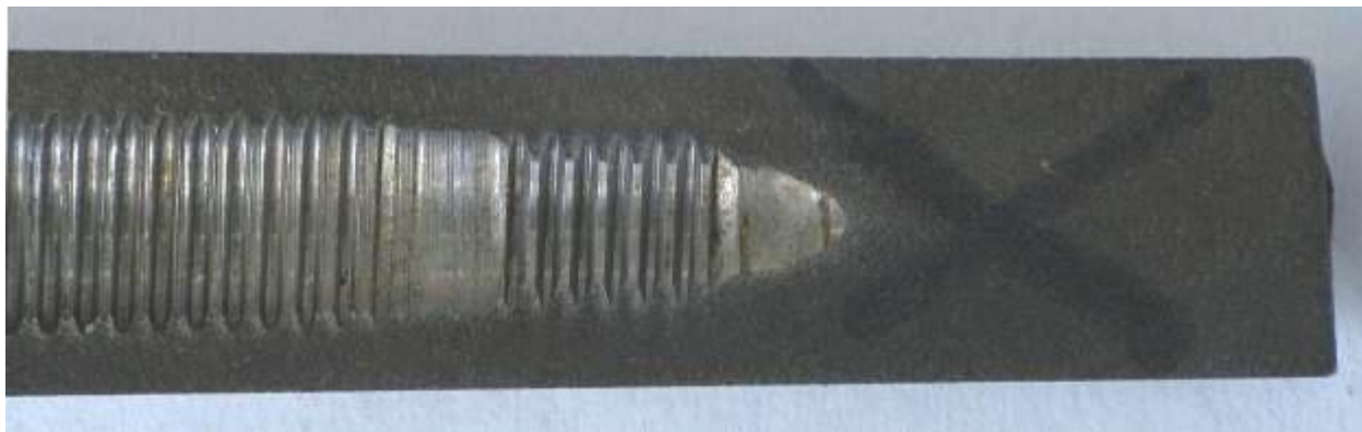
Рисунок 2.3 Внешний вид ниппельной части, вырезанной для заливки в шлиф
