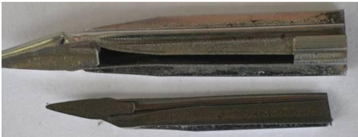
Рисунок 2.2 Внешний вид концевой фрагмента (прямоугольником выделена часть, вырезанная для заливки в шлиф)
