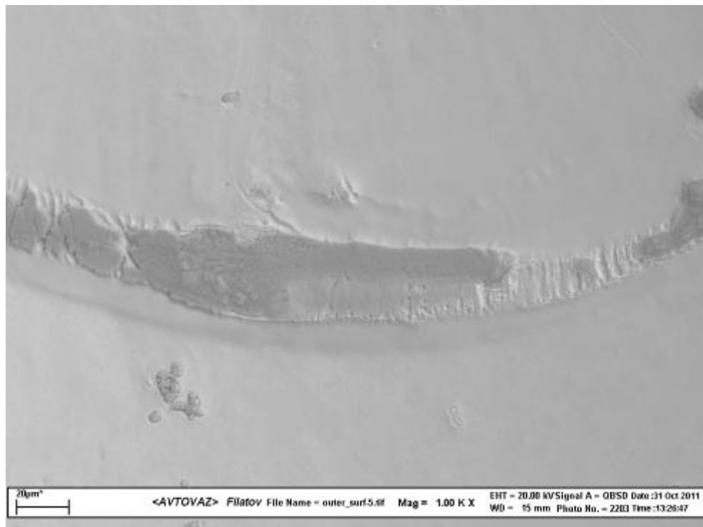
Рисунок 2.34 Электронно-микроскопическое изображение морфологии внешней поверхности трубки в зоне сварного шва
