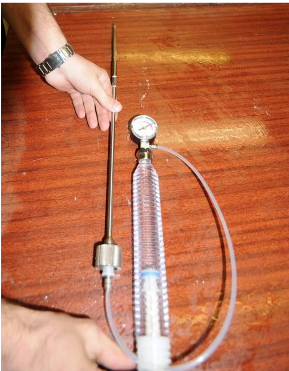
Рисунок 7.8 Оболочка после нагнетания давления 70 BAR
