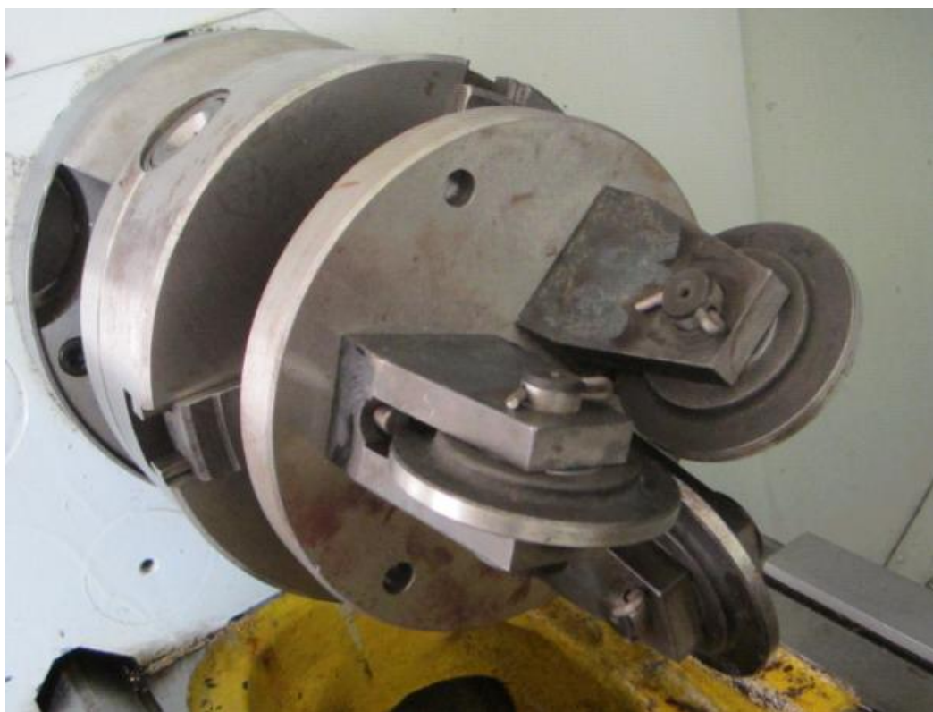
Рисунок 7.4 Приспособление для технологического ужатия
