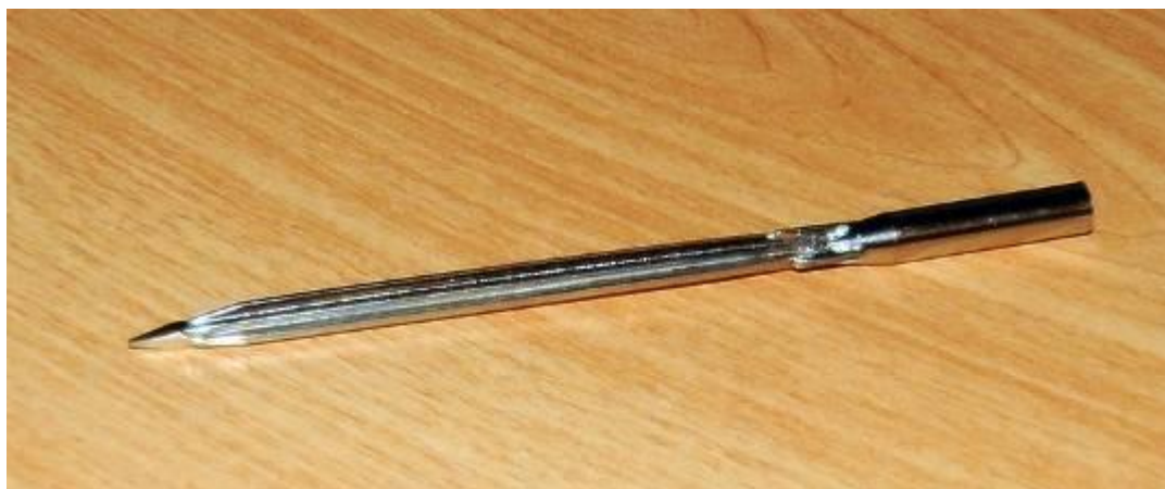
Рисунок 7.2 Образец оболочки для испытаний на герметичность
