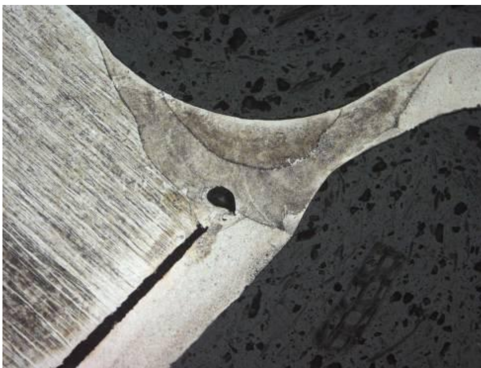
Рисунок 2.10 Микроструктура сварного соединения трубки и ребра жесткости
