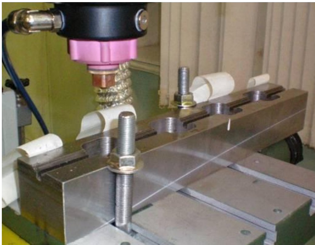
Рисунок 6.2 Интегрированное в систему станка приспособление для сварки изделий
