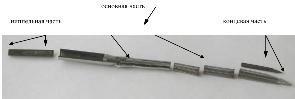
Рисунок 2.1 Внешний вид изделия и условное разделение на конструктивные элементы
