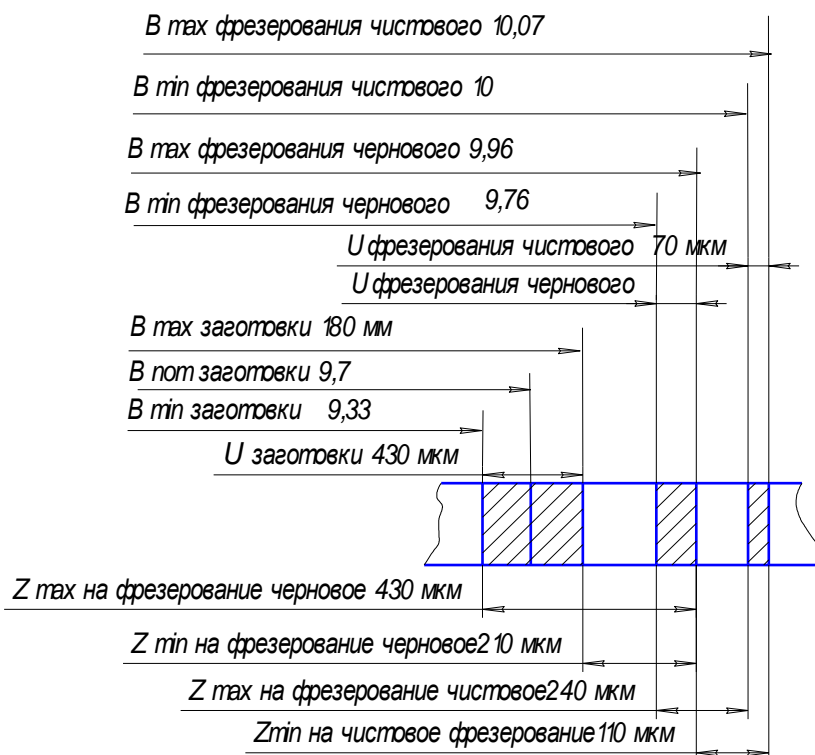
Рисунок 2.2 - Схема графического расположения припусков на обработку отверстия паза
