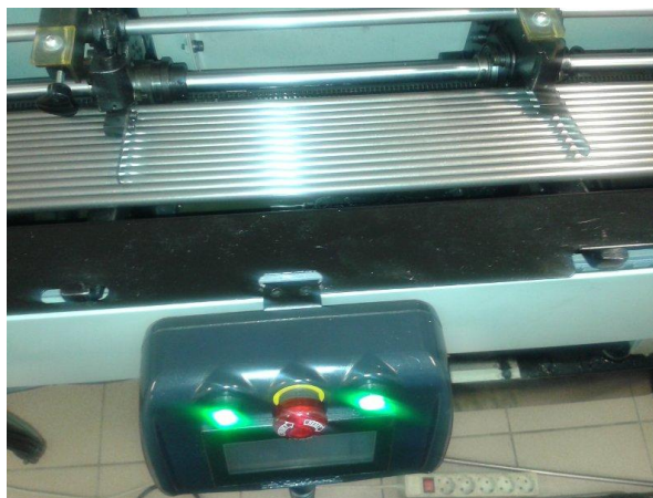
Рисунок 5.2- Расположение прутка в рабочей зоне системы «Барфидер»
