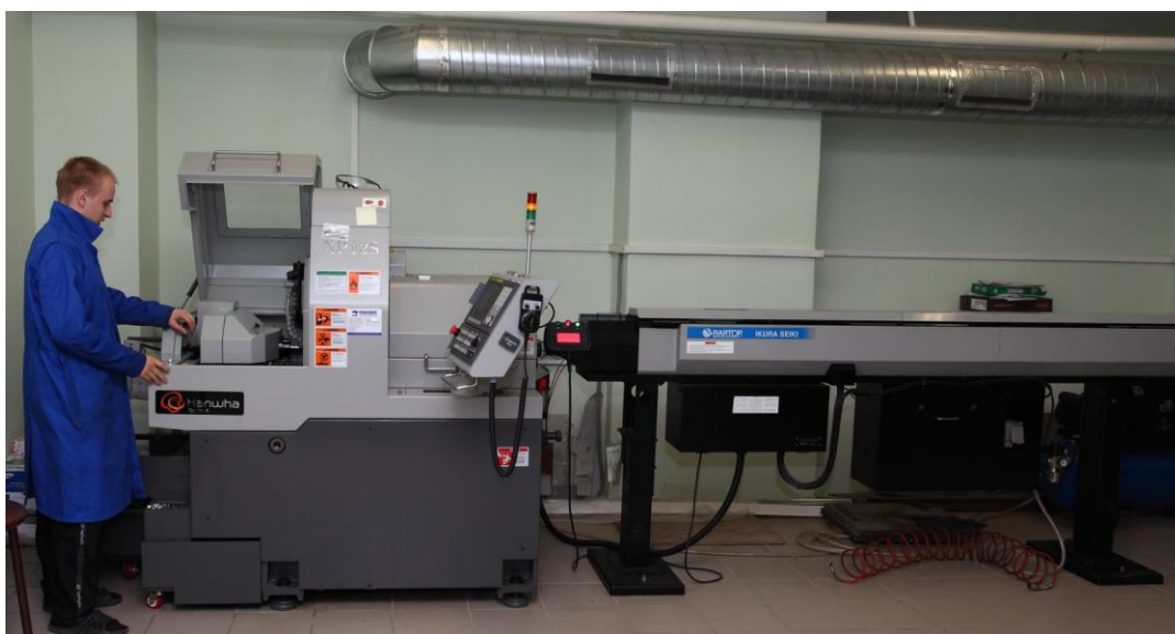
Рисунок 5.1 – Общий вид токарного пруткового автомата продольного точения с системой подачи прутка типа «Барфидер»
