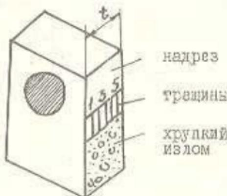
Рис. 6.1. Издам половины образца после разрушения
