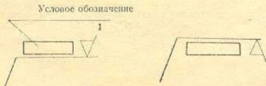
Рис. 8. Обозначение шероховатости обработанной поверхности сварного соединения
