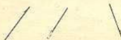
Рис. 10. Обозначения одинаковых швов линиями-выносками без полок
