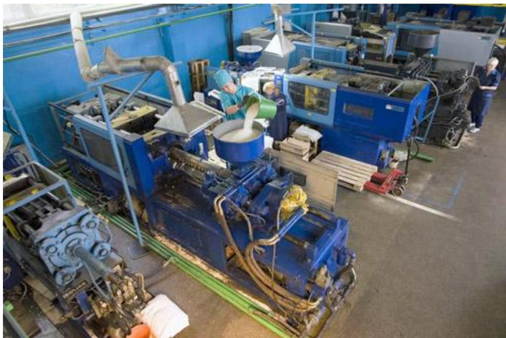
Рисунок 1.2- Участок с термопласт автоматами
