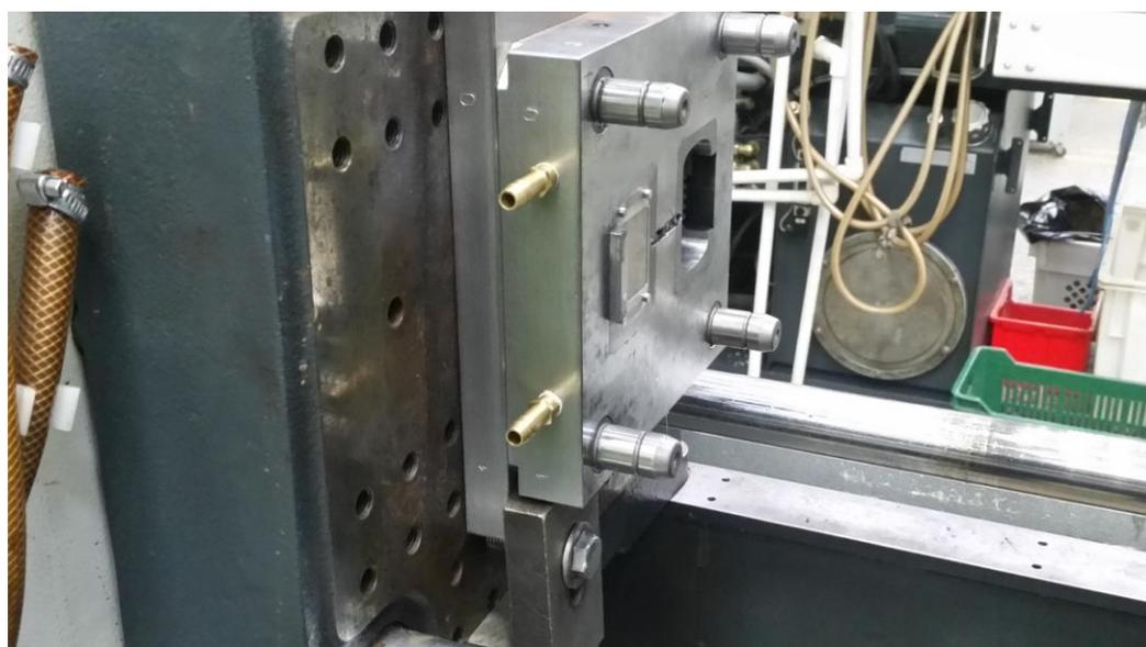
Рисунок 6.2 – Базовая рабочая зона термопласт – автомата
