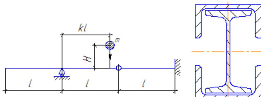
Принять:  $k=0,6$ ,  $H=0,2\text{м}$ ,  $l=0,5\text{м}$ , материал Ст 3,  $[\sigma]=160\text{МПа}$ ;  $E=2\times 10^5\text{МПа}$ , двутавр №10, швеллер №10.
