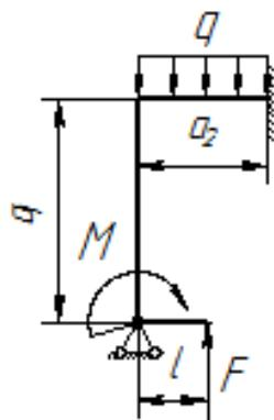
Принять:  $F=30\text{kH}$ ,  $M=40\text{kNm}$ ,  $q=20\text{kN/m}$ ,  $a_1=1,5\text{m}$ ,  $a_2=2\text{m}$ ,  $a_3=0,6\text{m}$ ,  $l=0,5\text{m}$ .
