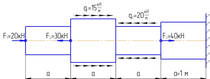
**Задача 2.** Для данной расчетной схемы построить эпюру крутящего момента  $M_z$ , используя метод построения по характерным сечениям.
