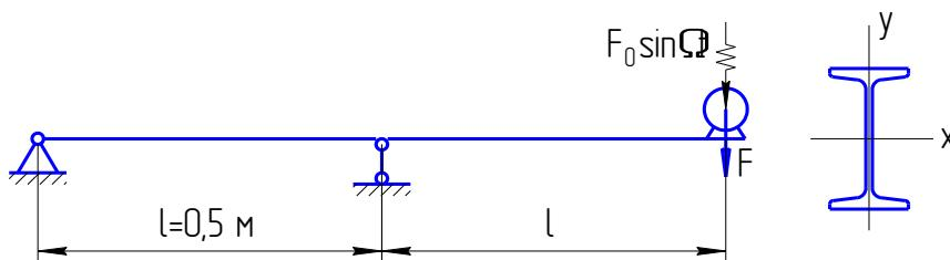
Произвести проверочный расчет на прочность подмоторной балки и определить значение  $l$ , при котором возможно наступление резонанса. Сопротивлением среды пренебречь. Допускаемое напряжение  $[\sigma]$  принять равным 160 МПа.
