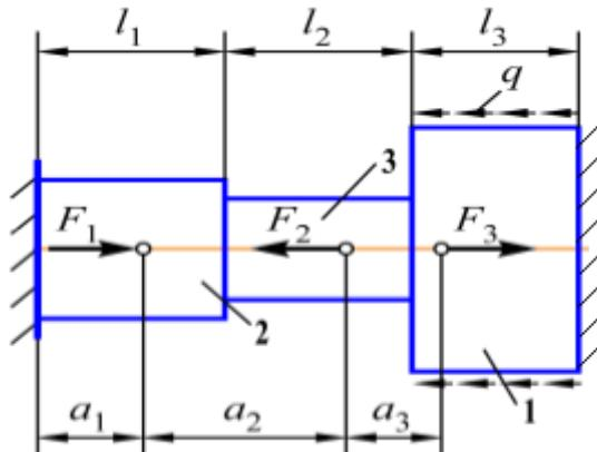
Где:  $F_1=20\text{kH}$ ,  $F_2=10\text{kH}$ ,  $F_3=30\text{kH}$ ,  $q=20\text{kH/m}$ ,  $l_1=0,8\text{м}$ ,  $l_2=1,5\text{м}$ ,  $l_3=1,2\text{м}$ ,  $a_1=0,5\text{м}$ ,  $a_2=1,4\text{м}$ ,  $a_3=0,7\text{м}$ ,  $\Delta t=-20^\circ\text{C}$ .
