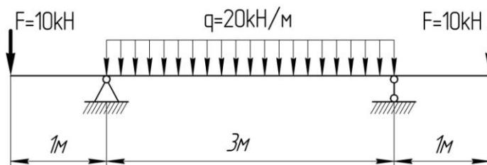
определить из условия прочности характерный размер  $a$  сложного поперечного сечения, предварительно решив вопрос о его рациональном положении.
