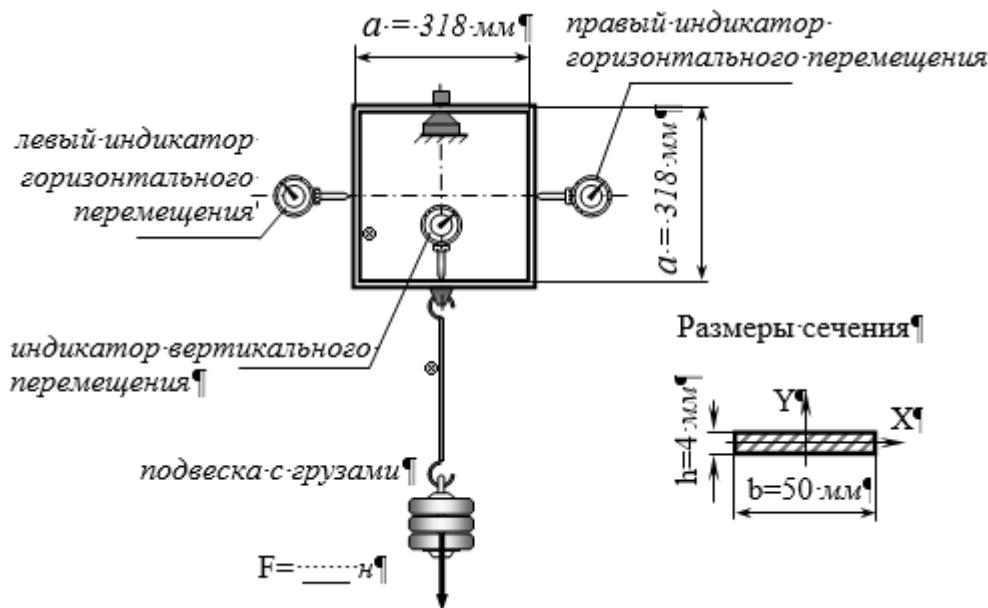
Экспериментально и теоретически определить значения горизонтального и вертикального перемещений в статически неопределенном замкнутом контуре. Сравнить результаты и сделать выводы.
