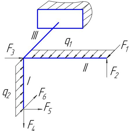
Принять:  $F_1=5\text{kH}$ ,  $F_2=2\text{kH}$ ,  $F_3=5\text{kH}$ ,  $F_4=3\text{kH}$ ,  $F_5=1\text{kH}$ ,  $F_6=0$ ,  $q_1=0$ ,  $q_2=2\text{kH}/\text{m}l=0,6\text{м}$ .
