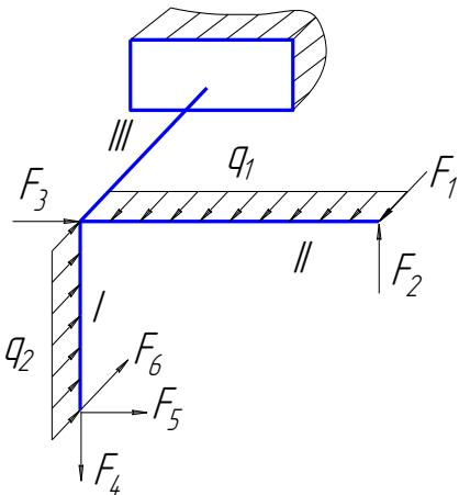
Принять:  $F_1=5\text{кН}$ ,  $F_2=2\text{кН}$ ,  $F_3=5\text{кН}$ ,  $F_4=3\text{кН}$ ,  $F_5=1\text{кН}$ ,  $F_6=0$ ,  $q_1=0$ ,  $q_2=2\text{кН}/\text{м}$ ,  $l=0,6\text{м}$ ,  $h/b=1,8$ ,  $[\sigma]=160\text{ МПа}$ .
