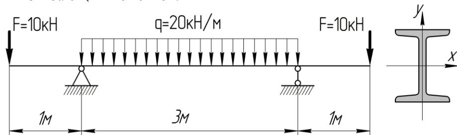
Провести проверку жесткости балки, если её поперечное сечение – двутавр №16 с осевым моментом инерции  $I_x = 873 \text{ см}^4$ . Принять:  $E = 2 \cdot 10^5 \text{ МПа}$ ,  $\bar{\sigma} = 0,001L$  (где  $L$  – расстояние между опорами).
