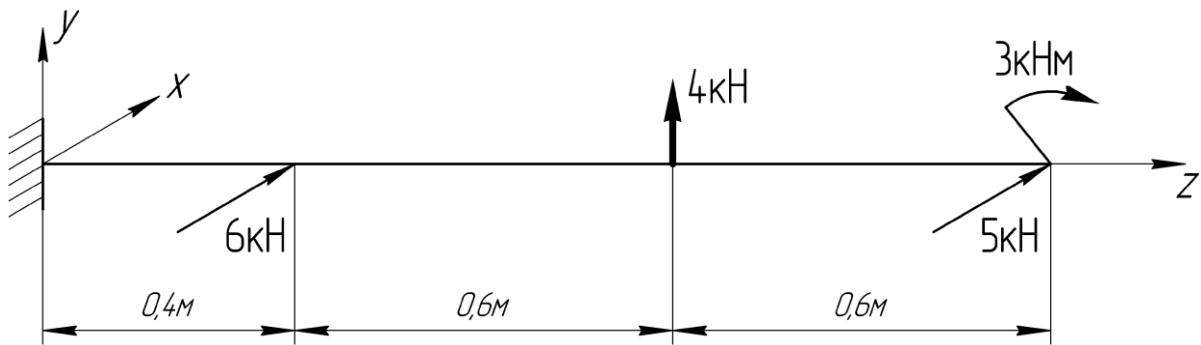
Длина стержня  $l = 1,6\text{м}$ , а соотношение сторон прямоугольного сечения  $h/b = 1,5$ . Стержень изготовлен из стали Ст3 с допускаемым напряжением  $[\sigma] = 160 \text{ МПа}$ . Определить из условия прочности характерный размер  $b$  прямоугольного сечения.
