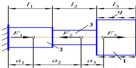
Принять:  $F_1=20\text{kH}$ ,  $F_2=10\text{kH}$ ,  $F_3=30\text{kH}$ ,  $q=20\text{kH/m}$ ,  $l_1=0,8\text{м}$ ,  $l_2=1,5\text{м}$ ,  $l_3=1,2\text{м}$ ,  $a_1=0,5\text{м}$ ,  $a_2=1,4\text{м}$ ,  $a_3=0,7\text{м}$ . Материал Сталь 40,  $\sigma_T=340\text{МПа}$ ,  $n_T=1,8$ .
