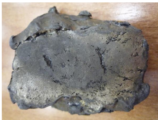
Рисунок 2.5 - Поверхность футеровки из стали Гадфильда после эксплуатации в шаровой мельнице
