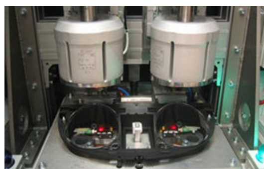
Рис. 1.8. Рабочие зоны сварки: а) чехла рычага переключения передачи, б) панели приборов автомобиля (разработка )HerrmannUltrasonic
