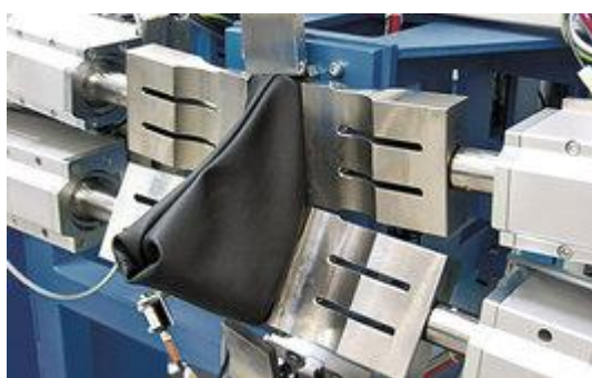
Рис. 1.8. Рабочие зоны сварки: а) чехла рычага переключения передачи, б) панели приборов автомобиля (разработка )HerrmannUltrasonic
