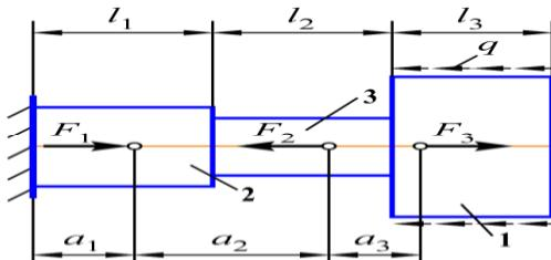
Где:  $F_1=20\text{kH}$ ,  $F_2=10\text{kH}$ ,  $F_3=30\text{kH}$ ,  $q=20\text{kH/m}$ ,  $l_1=0,8\text{м}$ ,  $l_2=1,5\text{м}$ ,  $l_3=1,2\text{м}$ ,  $a_1=0,5\text{м}$ ,  $a_2=1,4\text{м}$ ,  $a_3=0,7\text{м}$ .
