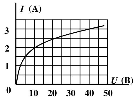
2. В нелинейной электрической цепи постоянного тока  $U_3 = 15$ . Статическое сопротивление  $R_{экв} = \dots$
