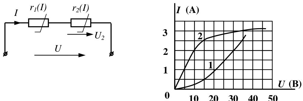
Если в нелинейной электрической цепи постоянного тока  $U_2 = 10$  В, то эквивалентное сопротивление  $R_{экв}$  равно ...
