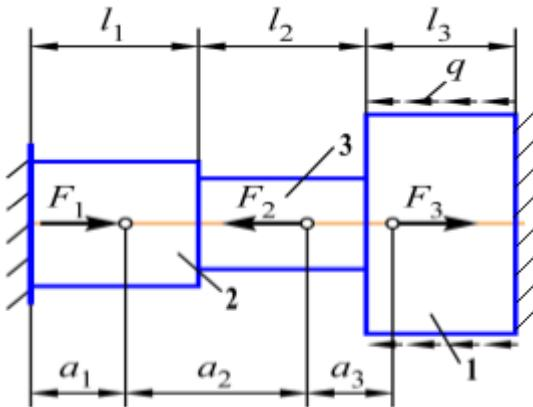
Где:  $F_1=20\text{kH}$ ,  $F_2=10\text{kH}$ ,  $F_3=30\text{kH}$ ,  $q=20\text{kH/m}$ ,  $l_1=0,8\text{м}$ ,  $l_2=1,5\text{м}$ ,  $l_3=1,2\text{м}$ ,  $a_1=0,5\text{м}$ ,  $a_2=1,4\text{м}$ ,  $a_3=0,7\text{м}$ ,  $\Delta t=-20^\circ\text{C}$ .
