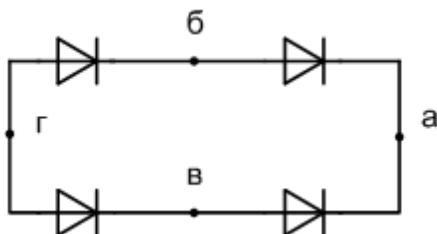
Укажите узлы в схеме к которым необходимо подключить переменное напряжение, чтобы на других узлах получить постоянное (выпрямленное) напряжение.
