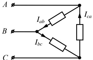
3. В симметричной трехфазной цепи, линейное напряжение  $U_L = 75$  В. Если сопротивление фазы «*a*» закорочено, то фазные напряжения приемников равны ... В.
