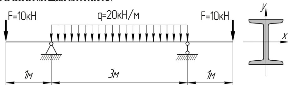
Провести проверку жесткости балки, если её поперечное сечение – двутавр №16 с осевым моментом инерции  $I_x = 873 \text{ см}^4$ . Принять:  $E = 2 \cdot 10^5 \text{ МПа}$ ,  $[\delta] = 0,001L$  (где  $L$  – расстояние между опорами).
