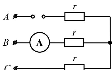
В симметричной трехфазной цепи, линейное напряжение  $U_{\text{Л}} = 100$  В. Сопротивление фазы приемника  $r = 10$  Ом.
