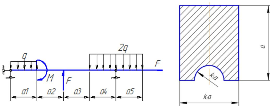
Принять:  $F=30\text{kH}$ ,  $M=40\text{kNm}$ ,  $q=20\text{kH/m}$ ,  $a_1=0,5\text{м}$ ,  $a_2=0,4\text{м}$ ,  $a_3=0,6\text{м}$ ,  $a_4=0,5\text{м}$ ,  $a_5=0,6\text{м}$ ,  $k_1=0,9$ ,  $k_3=0,3$ .
