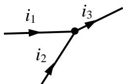
Известны мгновенные значения токов  $i_1(t) = 4 \cdot \sin(\omega t + 90^\circ)$  А и  $i_2(t) = 3 \cdot \sin(\omega t - 90^\circ)$  А. Амплитудное значение 3-го тока  $I_{m3}$  равно ... А.
