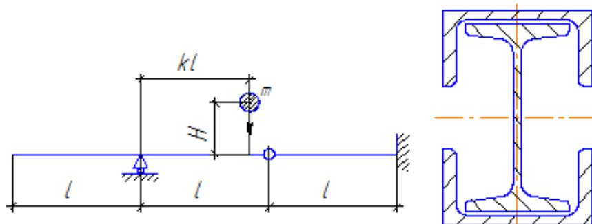
Принять:  $k=0,6$ ,  $H=0,2 \text{ м}$ ,  $l=0,5 \text{ м}$ , материал Ст 3,  $[\sigma]=160 \text{ МПа}$ ;  $E=2 \times 10^5 \text{ МПа}$ , двутавр №10, швеллер №10.
