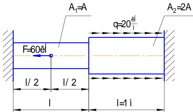
Определить, как изменится [A], если брус дополнительно к воздействию нагрузок будет нагрет на величину  $\Delta t=40^\circ\text{Си}$  если учесть, что брус изготовлен короче заданной длины на  $\delta=0,01\%(\ell_1+\ell_2)$ . Коэффициент линейного расширения  $\alpha=1,25\times10^{-5} \text{ } 1/\text{C}$ , модуль упругости  $E=2\times10^5$  МПа.
