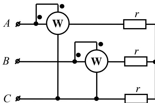
Если показания двух ваттметров 100 и 250 Вт, то потребляемая мощность симметричного трёхфазного приёмника составит ... Вт.
