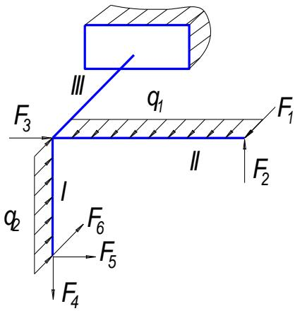
Принять:  $F_1=5\text{кН}$ ,  $F_2=2\text{кН}$ ,  $F_3=5\text{кН}$ ,  $F_4=3\text{кН}$ ,  $F_5=1\text{кН}$ ,  $F_6=0$ ,  $q_1=0$ ,  $q_2=2\text{кН}/\text{м}l=0,6\text{м}$ ,  $h/b=1,8$ ,  $[\sigma]=160\text{ МПа}$ .
