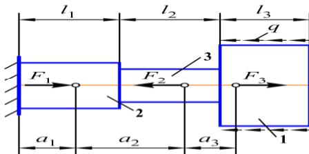
Принять:  $F_1=20\text{kH}$ ,  $F_2=10\text{kH}$ ,  $F_3=30\text{kH}$ ,  $q=20\text{kH/m}$ ,  $l_1=0,8\text{м}$ ,  $l_2=1,5\text{м}$ ,  $l_3=1,2\text{м}$ ,  $\alpha_1=0,5\text{м}$ ,  $\alpha_2=1,4\text{м}$ ,  $\alpha_3=0,7\text{м}$ . Материал Сталь 40,  $\sigma_T=340\text{МПа}$ ,  $n_T=1,8$ .
