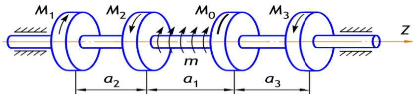
Принять:  $M_1=1,6\text{кНм}$ ,  $M_2=2\text{кНм}$ ,  $M_3=2\text{кНм}$ ,  $m=8\text{кНм}/\text{м}$ ,  $a_1=0,5\text{м}$ ,  $a_2=0,3\text{м}$ ,  $a_3=0,2\text{м}$ .
