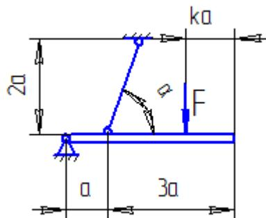
Принять:  $a=0,4\text{м}$ ,  $\alpha=30^\circ$ ,  $k=1,5$ ,  $A=6 \times 10^{-4}\text{м}^2$ ,  $\sigma_T=260\text{МПа}$ ,  $n_T=1,6$ .
