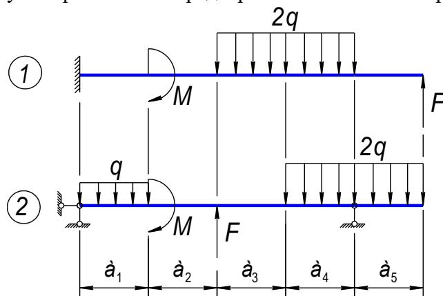
Принять:  $F=30\text{кН}$ ,  $M=40\text{кНм}$ ,  $q=20\text{кН}/\text{м}$ ,  $a_1=0,5\text{м}$ ,  $a_2=0,4\text{м}$ ,  $a_3=0,6\text{м}$ ,  $a_4=0,5\text{м}$ ,  $a_5=0,6\text{м}$ .
