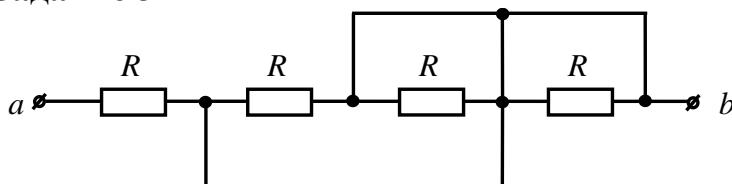
В линейной электрической цепи постоянного тока  $R = 9 \text{ Ом}$ . Величина эквивалентного сопротивления цепи  $R_{ab}$  равна ... Ом.
