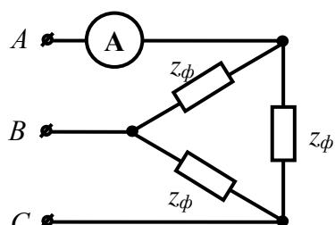
В симметричной трехфазной цепи, линейное напряжение  $U_{\text{Л}} = 100$  В.
