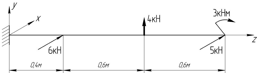
Длина стержня  $l = 1,6\text{м}$ , а соотношение сторон прямоугольного сечения  $h/b = 1,5$ . Стержень изготовлен из стали Ст3 с допускаемым напряжением  $[\sigma] = 160 \text{ МПа}$ . Определить положение опасных точек и нейтральной линии в опасном сечении, а также найти из условия прочности по изгибу характерный размер  $b$  прямоугольного сечения. Определить смещение нейтральной линии от центра тяжести сечения и вычислить перенапряжение от действия продольной силы. Дать оценку прочности.
