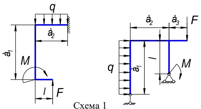
Принять:  $F=30\text{кН}$ ,  $M=40\text{кНм}$ ,  $q=20\text{кН}/\text{м}$ ,  $a_1=1,5\text{м}$ ,  $a_2=2\text{м}$ ,  $a_3=0,6\text{м}$ ,  $l=0,5\text{м}$ .
