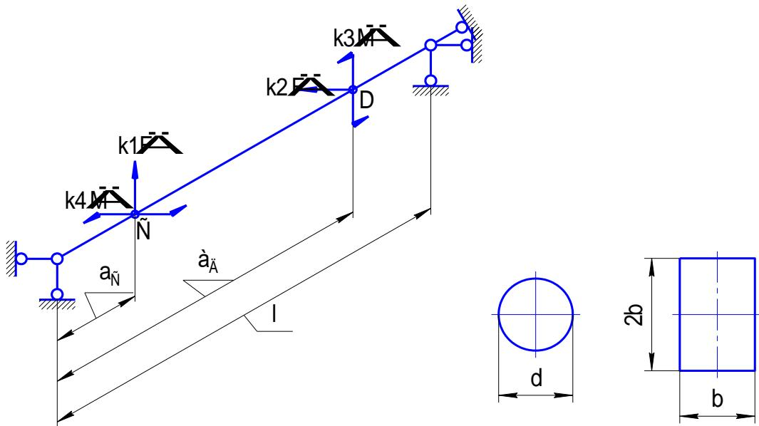
Принять:  $k_1=1$ ,  $k_2=2$ ,  $k_3=3$ ,  $k_4=4$ ,  $a_c=1\text{м}$ ,  $a_D=3\text{м}$ ,  $l=6\text{м}$ ,  $d=90\text{мм}$ ,  $\sigma_T=380\text{МПа}$ ; сечение D.
