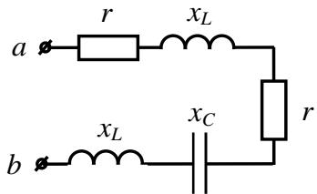
3. Определить активную ( $P$ ), реактивную ( $Q$ ) и полную ( $S$ ) мощность цепи, если закон изменения тока и приложенного напряжения:  $i = 4 \sin(\omega t - 30^\circ)$  А,  $u = 25 \sin(\omega t + 30^\circ)$  В.
