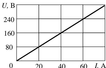
При заданной вольт-амперной характеристике приемника его проводимость составит ...
