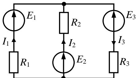
Указано истинное направление токов в ветвях электрической цепи, источники ЭДС работают в режимах ...
