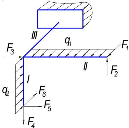
Принять:  $F_1=5\text{кН}$ ,  $F_2=2\text{кН}$ ,  $F_3=5\text{кН}$ ,  $F_4=3\text{кН}$ ,  $F_5=1\text{кН}$ ,  $F_6=0$ ,  $q_1=0$ ,  $q_2=2\text{кН}/\text{м}l=0,6\text{м}$ .
