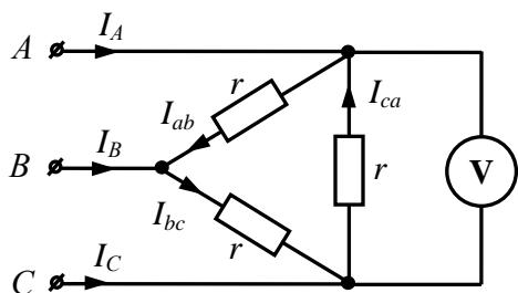
2. Фазные токи симметричного трехфазного потребителя равны  $I_{ab} = I_{bc} = I_{ca} = 12$  А. Какими будут фазные и линейные токи в случае, если
