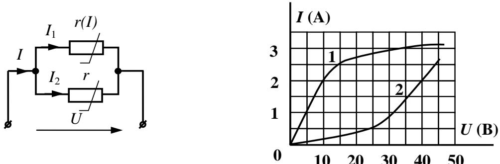
В нелинейной электрической цепи постоянного тока  $I_1 = 3$ , тогда  $I_2$  равен ... А.
