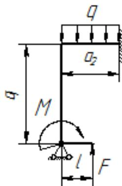
Принять:  $F=30\text{kH}$ ,  $M=40\text{kNm}$ ,  $q=20\text{kN/m}$ ,  $a_1=1,5\text{m}$ ,  $a_2=2\text{m}$ ,  $a_3=0,6\text{m}$ ,  $l=0,5\text{m}$ .
