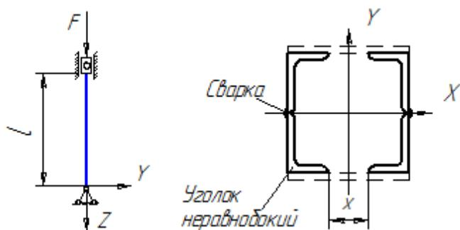
Принять:  $l=8,5\text{м}$ , уголок неравнобокий №11/7, материал Ст 2,  $[\sigma]=140\text{МПа}$ ,
