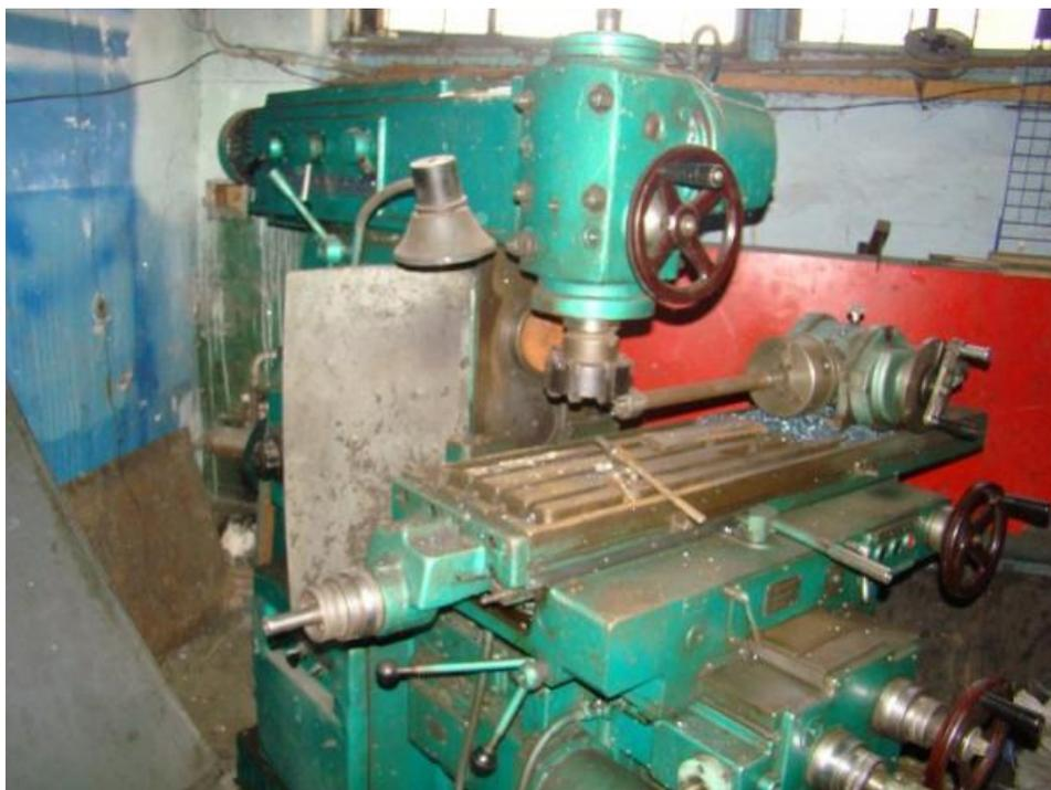
Рисунок 1.2 – Универсальный фрезерный станок для обработки металлов
