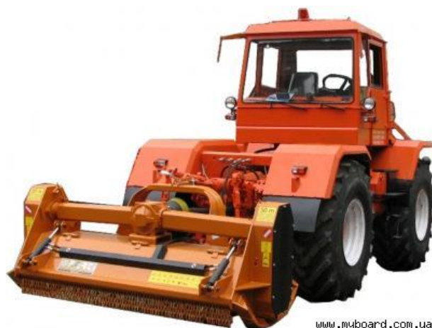
Рисунок 1.9 - Лесотехнический измельчитель (кусторез) на базе трактора ХТА-200-02
