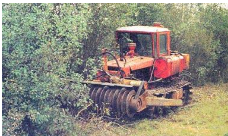
Рисунок 1.10 - Расчистки полосы отвода кусторезом на базе трактора ДТ-75
