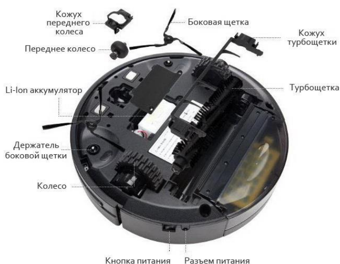
Рисунок 1.1- Устройство робота-уборщика
