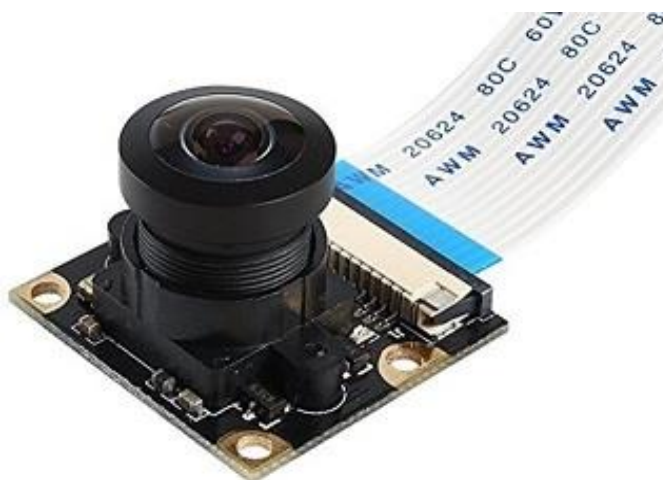
Рисунок 2.2.1 – Камера Raspberry Pi Compatible Fisheye Camera
