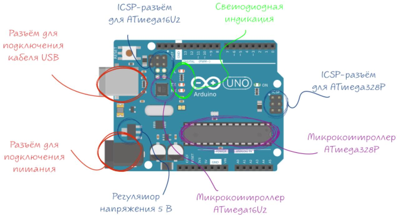
Рисунок 11- Элементы платы Arduino
