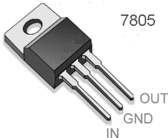
Рисунок 31- Назначение выводов стабилизатора напряжения
