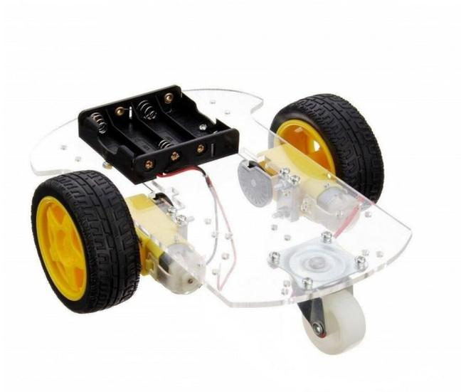
Рисунок 28 - Корпус робота
