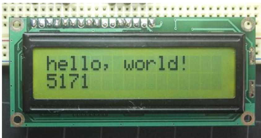
Рисунок 3.5 - LCD дисплей
