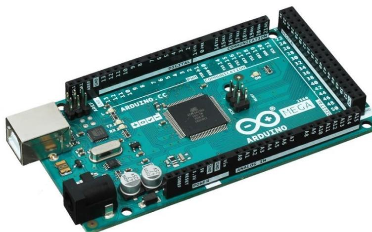
Рисунок 3.3 - Микроконтроллер Arduino Mega
