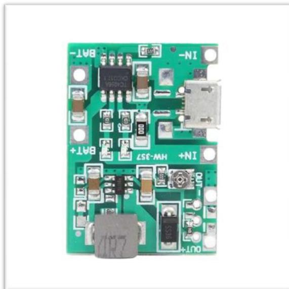
Рисунок 3.13 - Внешний вид контроллера заряда HW-357
