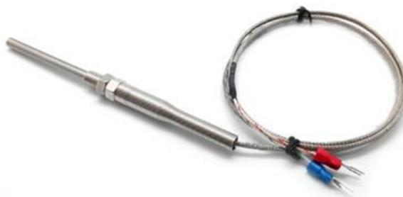
Рисунок 2 – Термопара
