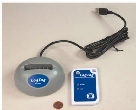
Рисунок 22 - USB-интерфейс для подключения к компьютеру
