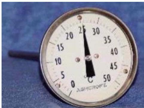
Рисунок 9 – Биметаллический термометр компании Ashcroft Inc
