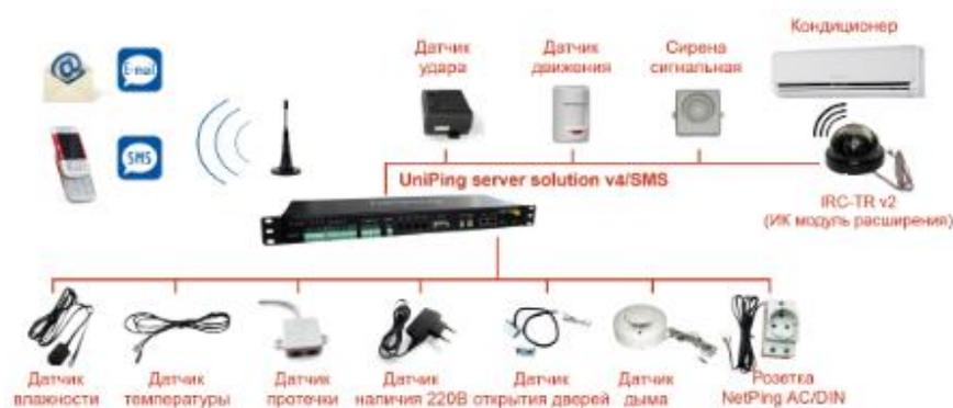
Рисунок 19 – Пример возможностей UniPing server solution v4/SMS
