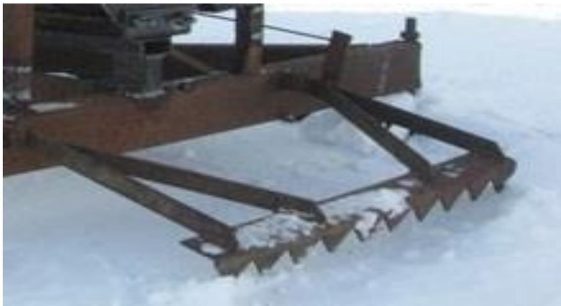
Рисунок 14 – Тормозная система
