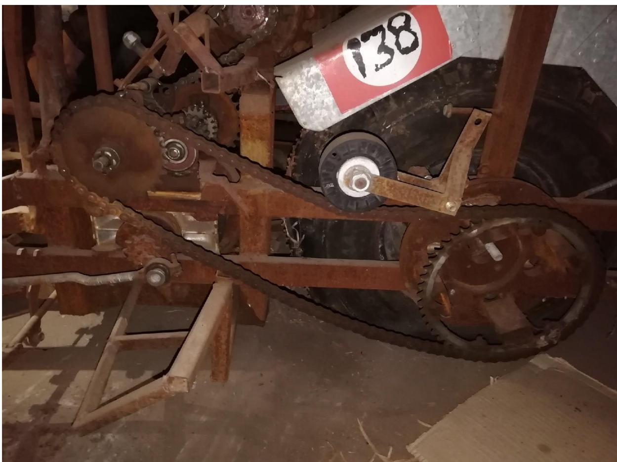
Рисунок А.1 – цепная передача
