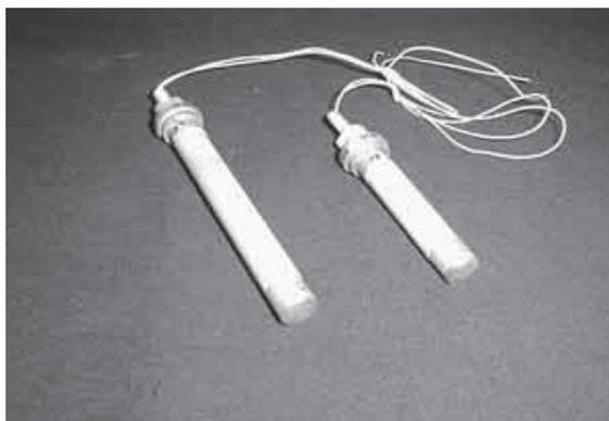
Рис. 2.8. Актюаторы трубчатые
