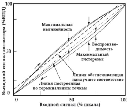
Рис. 2.13. Линейность пьезоматериалов
