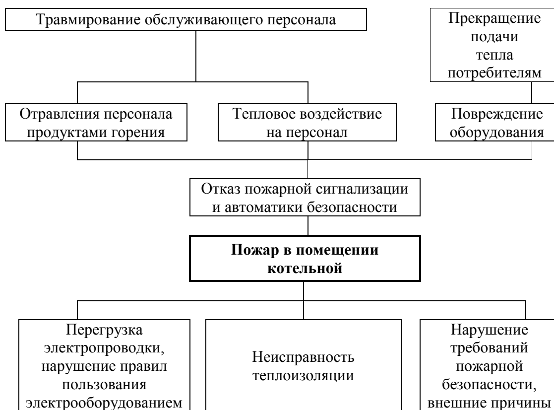
Рисунок 15 – Сценарий 15 пожар в помещении котельной
