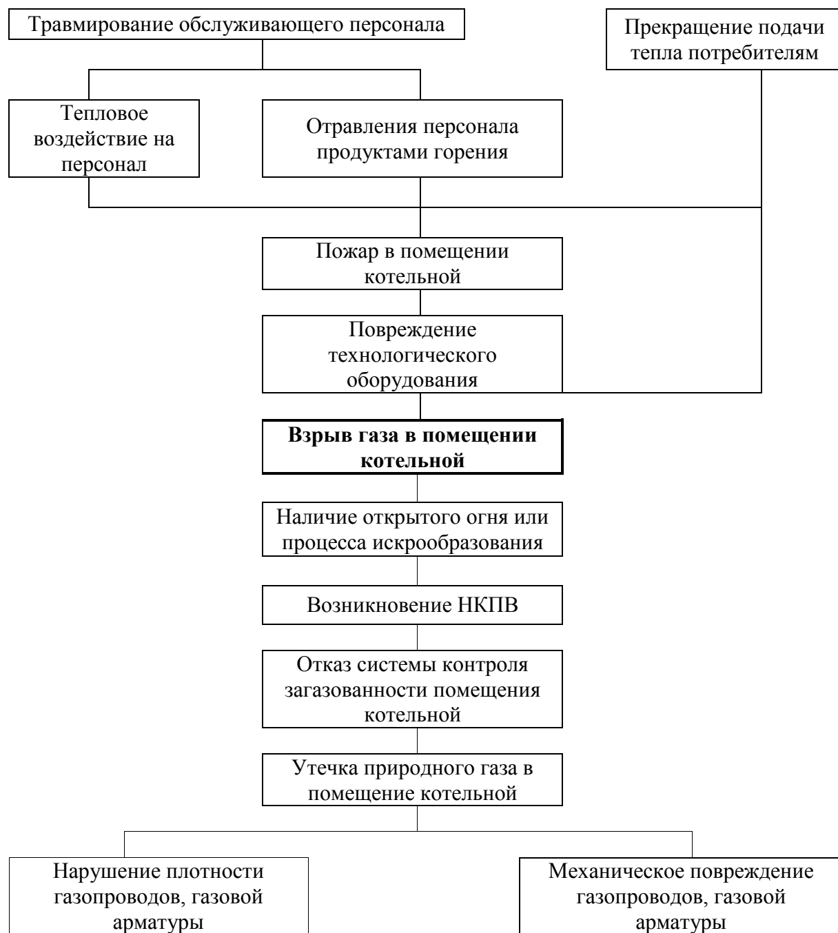
Рисунок 1 – Сценарий 1 взрыв газа в помещении котельной
