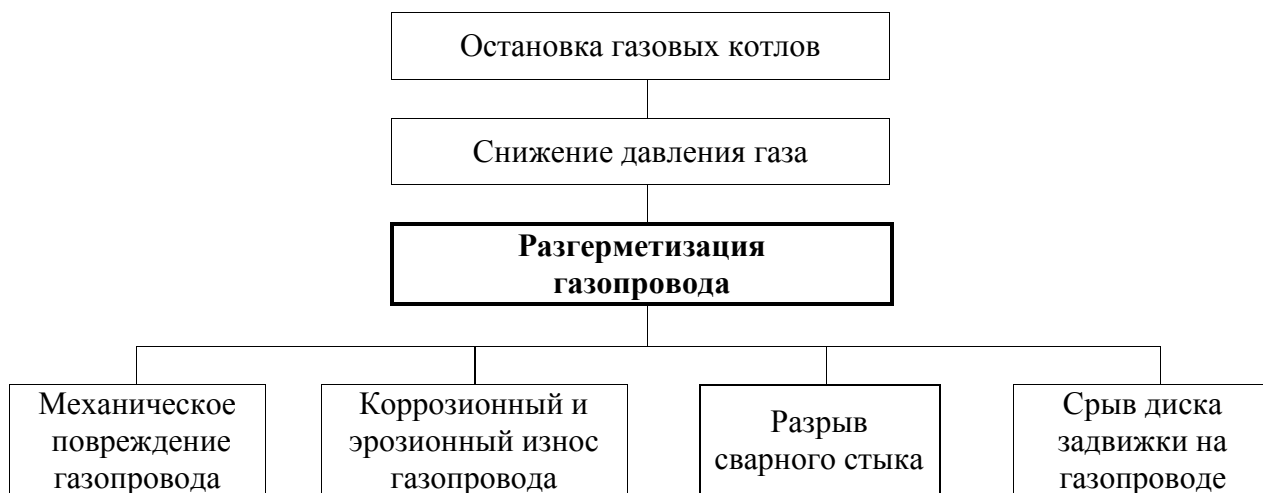
Рисунок 5 – Сценарий 5 разгерметизация газопровода
