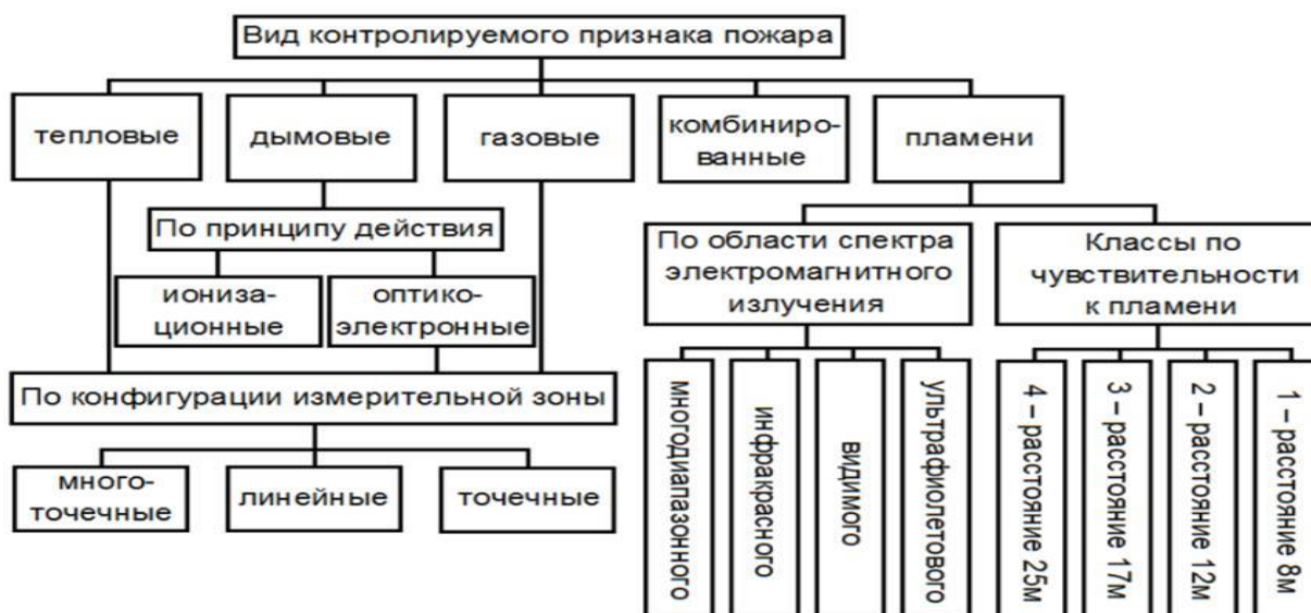
Рисунок 1.13 - Классификация автоматических пожарных извещателей по виду контролируемого признака пожара
