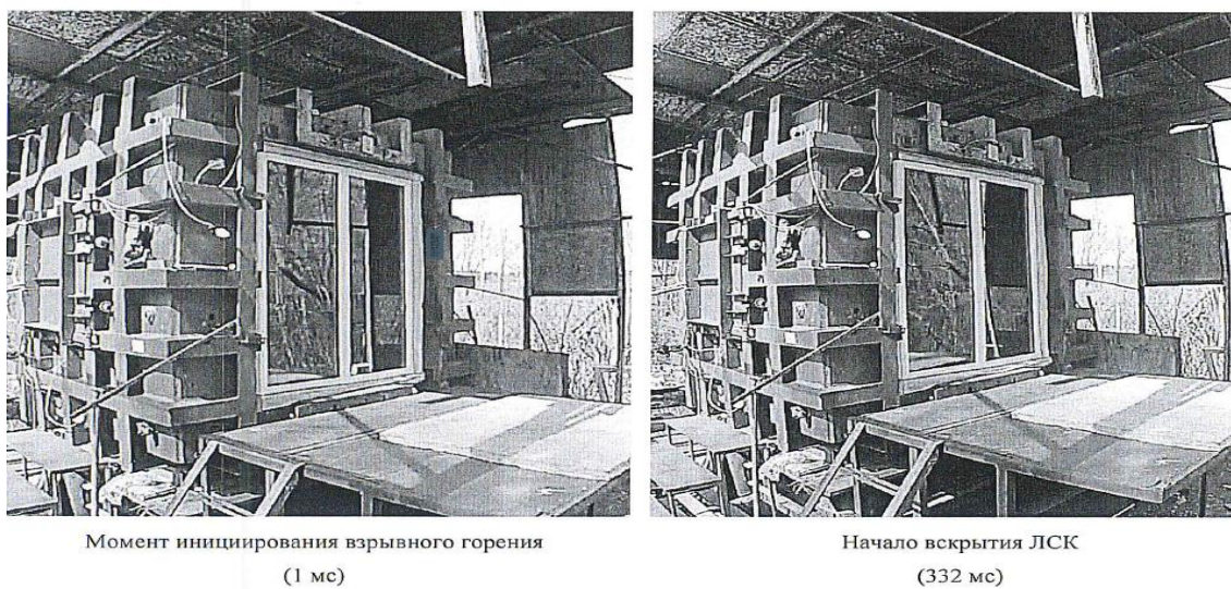
Рисунок 3.4 - Момент инициирования горения. Начало вскрытия ЛСК
