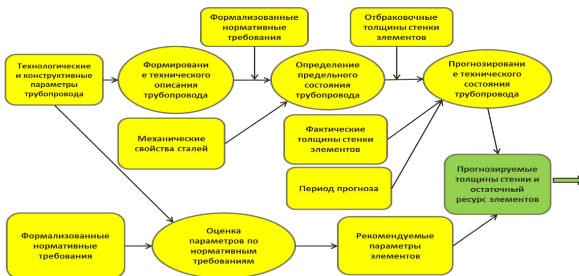
Рисунок 2 – Структурная схема физической модели единичного участка трубопровода с описанием технологических процессов его диагностирования и технического обслуживания
